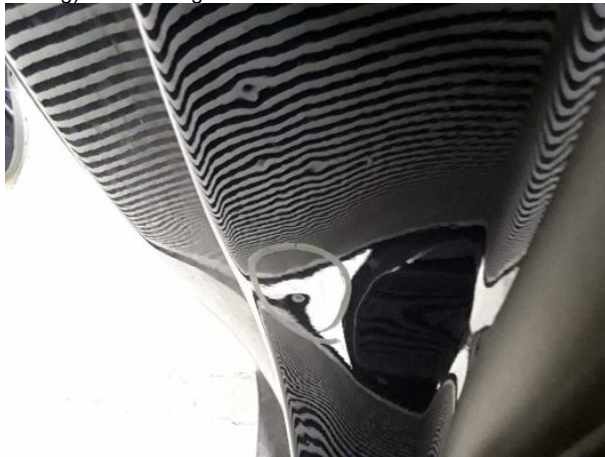
Beschädigung #3: Seitenwand rechts: Einstieg - Delle(n) - sanft instandsetzen
