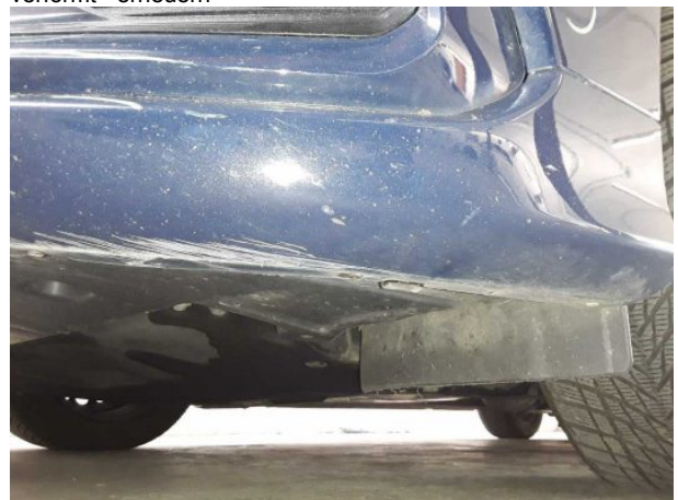
Beschädigung #7: Stossfänger vorn: Stossfänger vorn - verformt - erneuern
