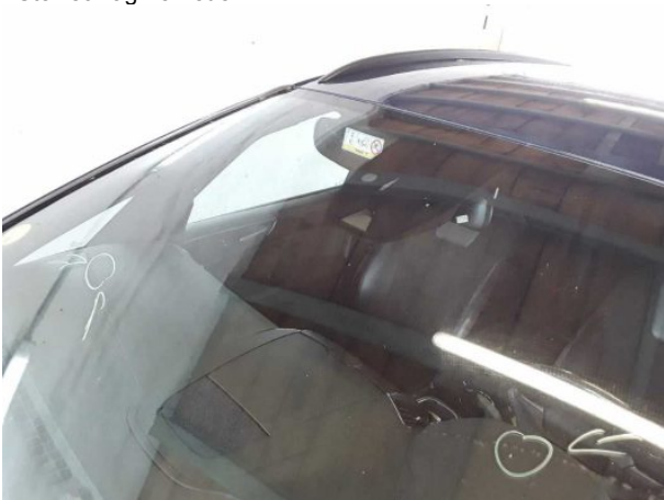
Beschädigung #8: Verglasung: Frontscheibe heizbar (Rissbildung... - Steinschlag - erneuern
