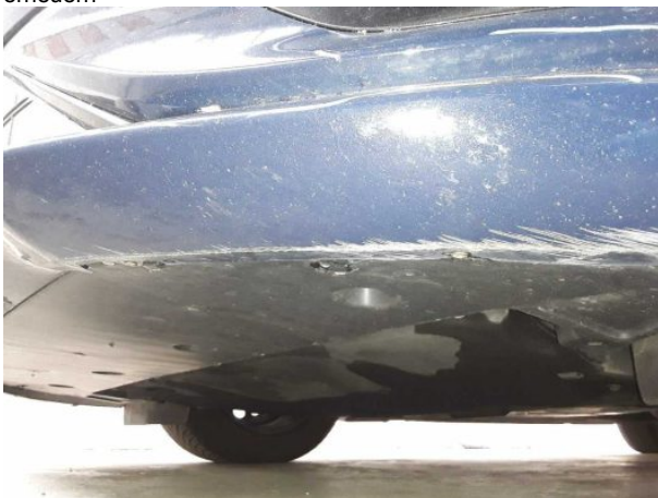
Beschädigung #7: Stossfänger vorn: Stossfänger vorn - verformt - erneuern
