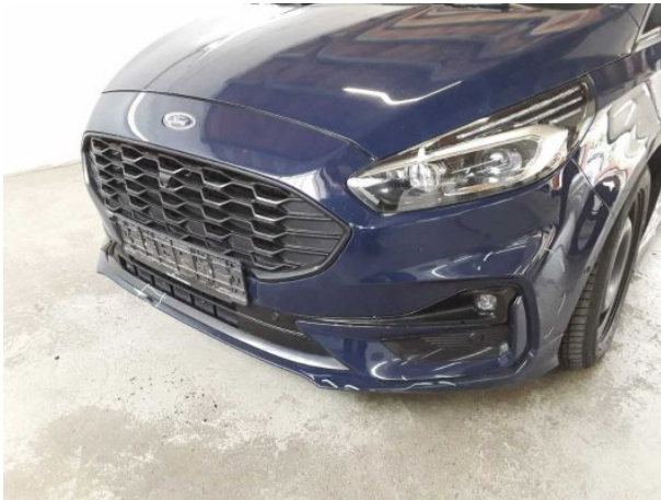
Beschädigung #7: Stossfänger vorn: Stossfänger vorn - verformt - erneuern
