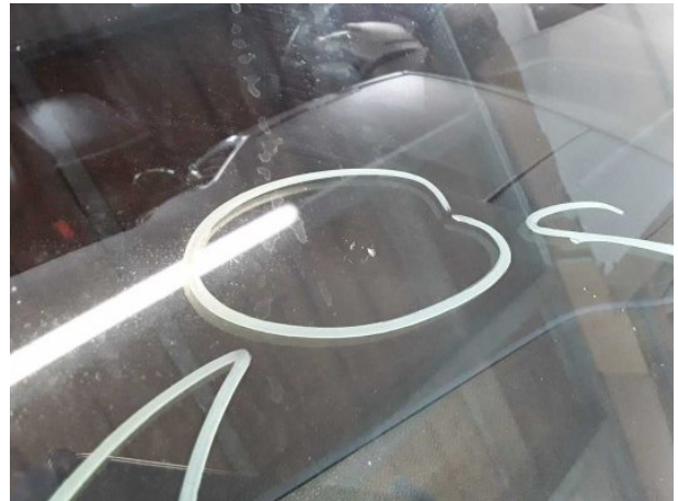
Beschädigung #8: Verglasung: Frontscheibe heizbar (Rissbildung) - Steinschlag - erneuern
