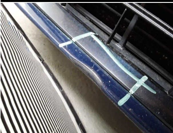
Beschädigung #7: Stossfänger vorn: Stossfänger vorn - verformt - erneuern
