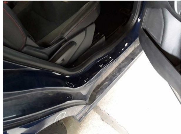
Beschädigung #3: Seitenwand rechts: Einstieg - Delle(n) - sanft instandsetzen
