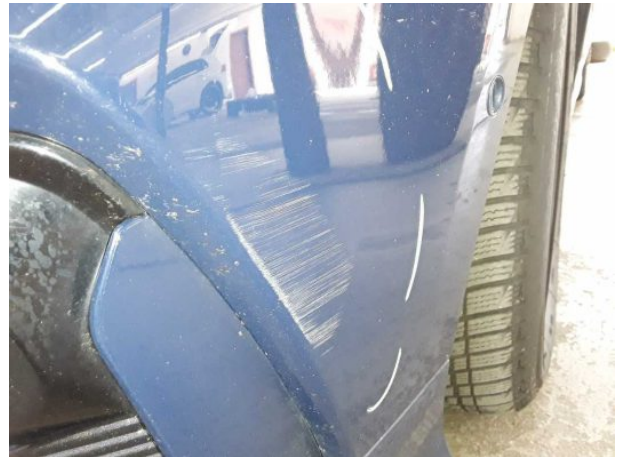
Beschädigung #7: Stossfänger vorn: Stossfänger vorn - verformt - erneuern
