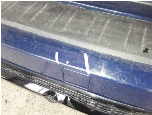
Beschädigung #5: Stossfänger hinten: Stossfänger hinten - verkratzt / verschürft - instandsetzen und lackieren
