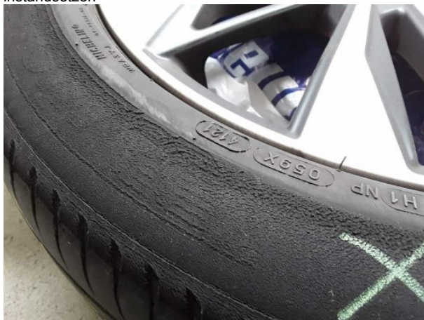
Beschädigung #4: 2.Radsatz: Reifensatz komplett - verschlissen - erneuern
