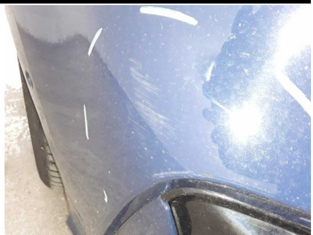
Beschädigung #7: Stossfänger vorn: Stossfänger vorn - verformt - erneuern
