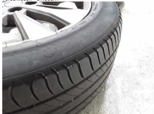
Beschädigung #4: 2.Radsatz: Reifensatz komplett - verschlissen - erneuern
