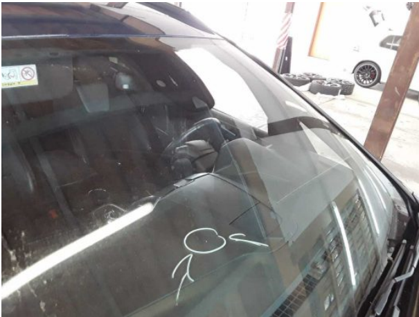
Beschädigung #8: Verglasung: Frontscheibe heizbar (Rissbildung... - Steinschlag - erneuern
