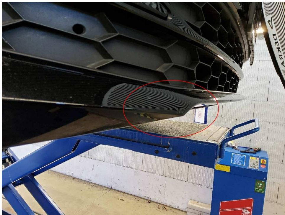
Bild 19 : Stoßfänger vorne, eingedellt, verschrammt
