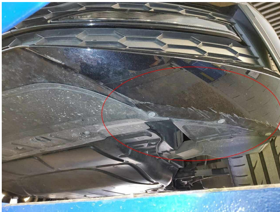
Bild 17 : Stoßfänger vorne, eingedellt, verschrammt
