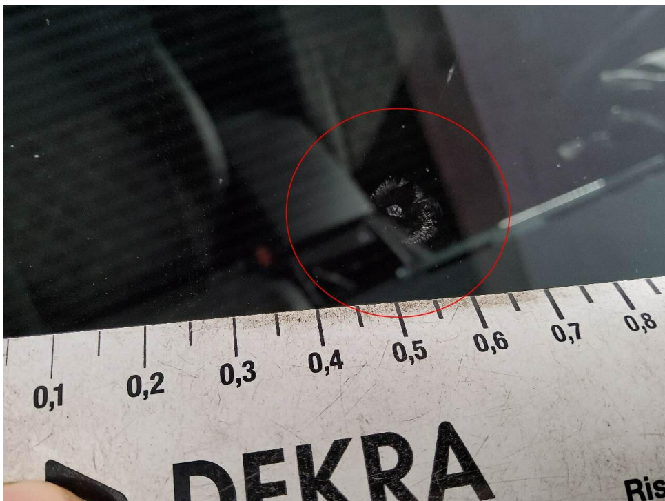
Bild 16 : Frontscheibe, reparierter Steinschlag mit Rissbildung
