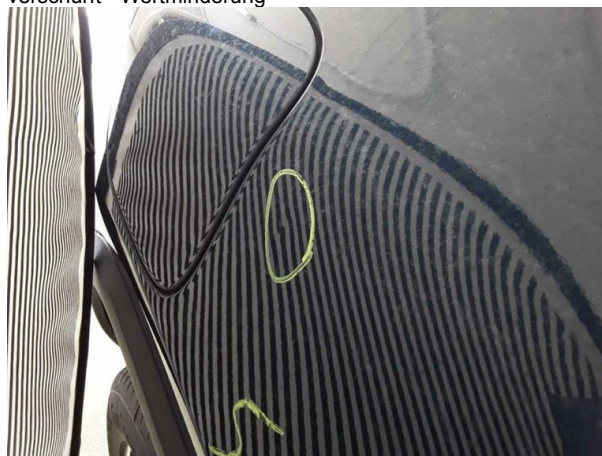
Beschädigung #5: Seitenwand rechts: Seitenwand - Delle(n) - sanft instandsetzen
