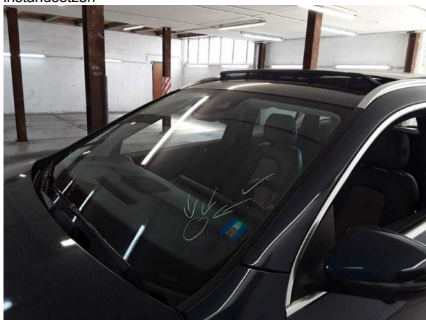
Beschädigung #8: Verglasung: Frontscheibe (Rissbildung) - Steinschlag - erneuern
