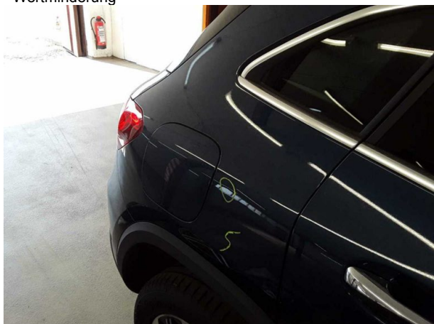
Beschädigung #5: Seitenwand rechts: Seitenwand - Delle(n) - sanft instandsetzen
