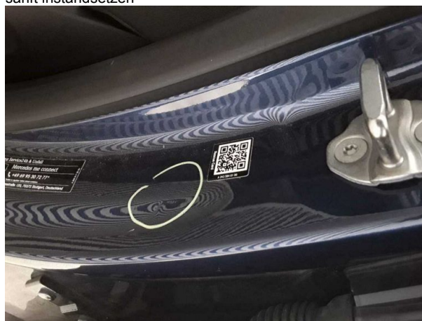
Beschädigung #3: Schweller links: Einstieg - Delle(n) - sanft instandsetzen
