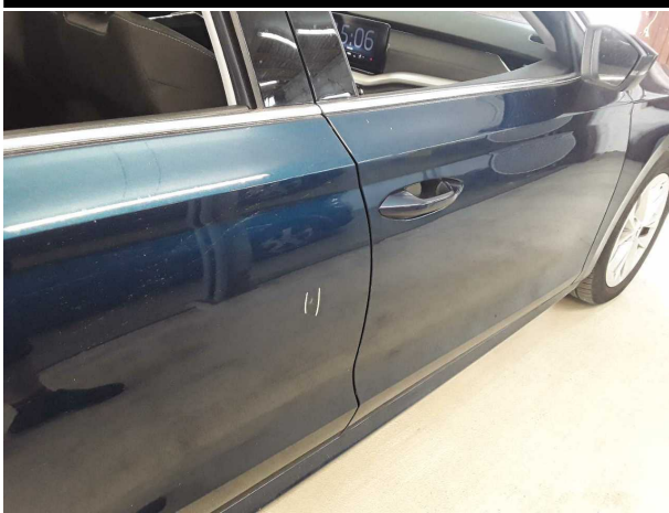
Beschädigung #3: Tür vorn rechts: Tür - verkratzt / verschürft - instandsetzen und lackieren
