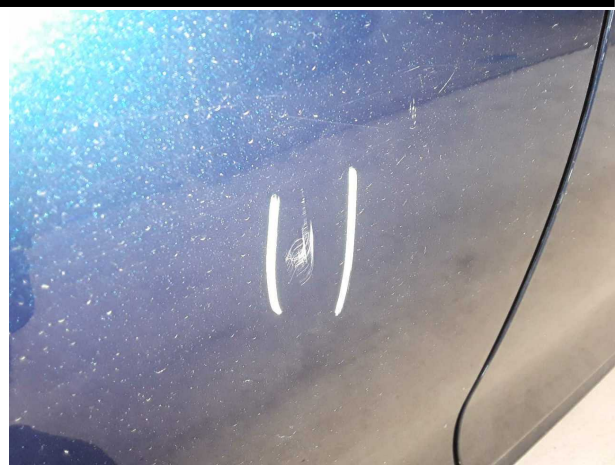
Beschädigung #3: Tür vorn rechts: Tür - verkratzt / verschürft... instandsetzen und lackieren
