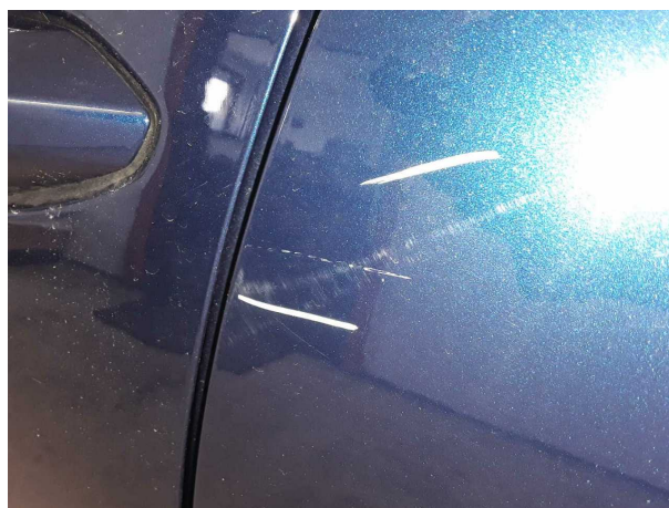
Beschädigung #1: Tür hinten links: Tür - verkratzt / verschürft... Smart Repair
