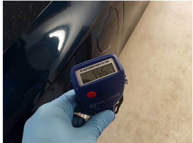
Nachlackierung 1: Kotflügel links, Seitenwand rechts
