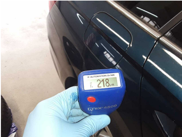
Nachlackierung 1: Kotflügel links, Seitenwand rechts
