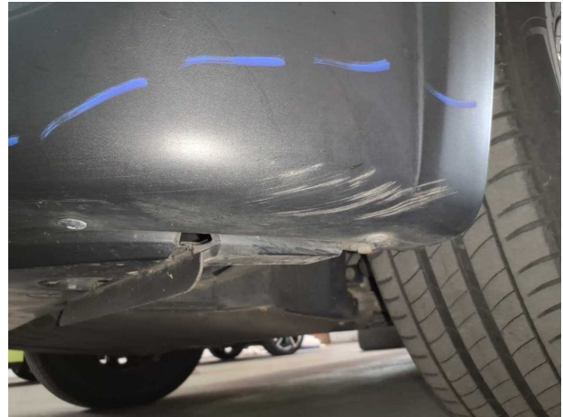
Beschädigung #2: Stossfänger vorn: Spoiler - verkratzt / verschürft - erneuern
