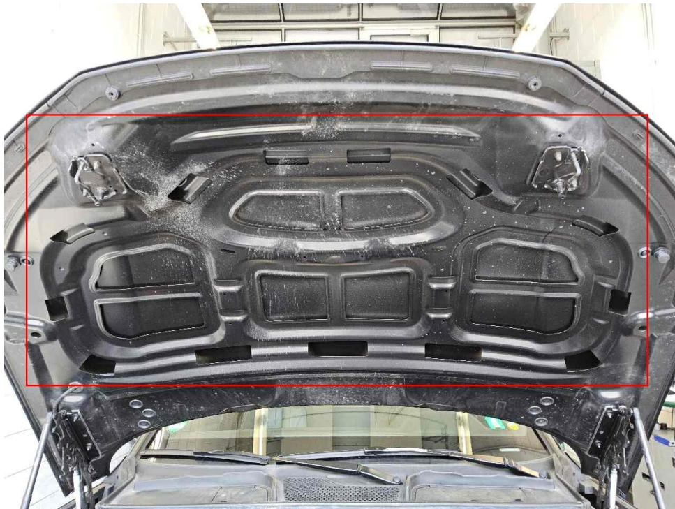
Bild 16 : Dämmmatte Motorhaube fehlt
