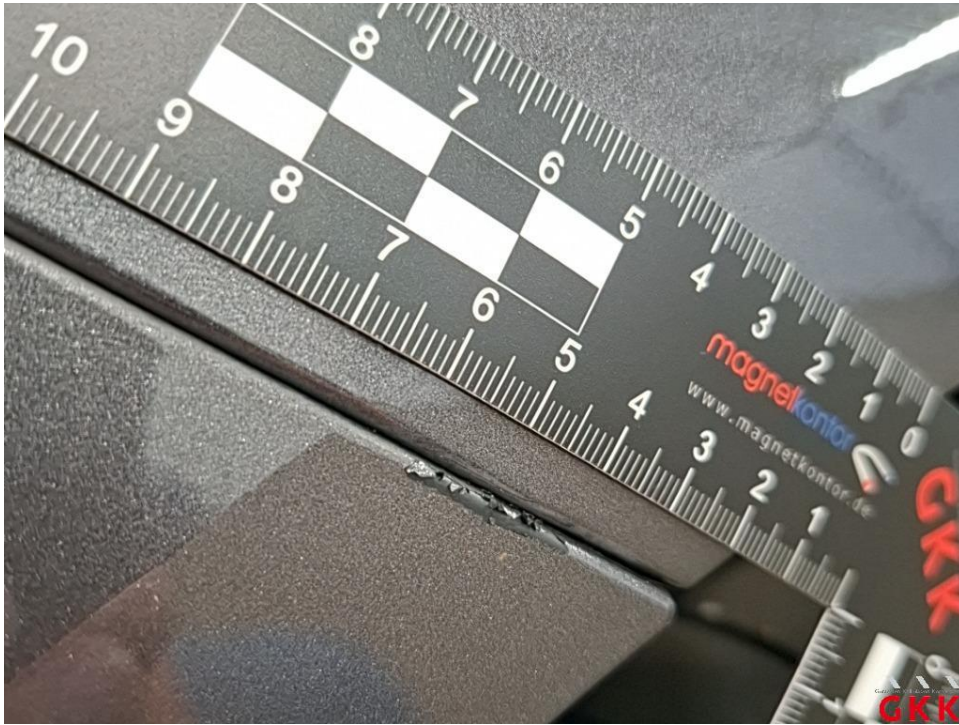
Bild 30 Stoßfänger hinten, Verkleidung -lackiert-, verkratzt, lackieren
