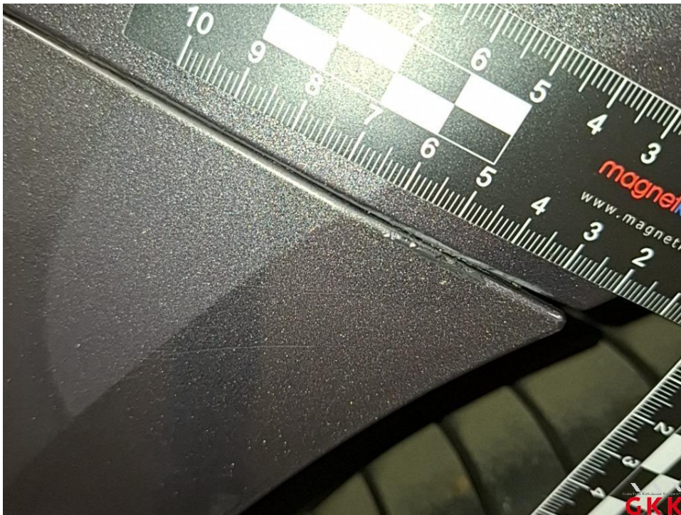
Bild 29 Stoßfänger hinten, Verkleidung -lackiert-, verkratzt, lackieren
