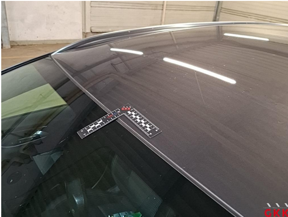
Bild 15 Dach, beschädigt, instand setzen - lackieren
