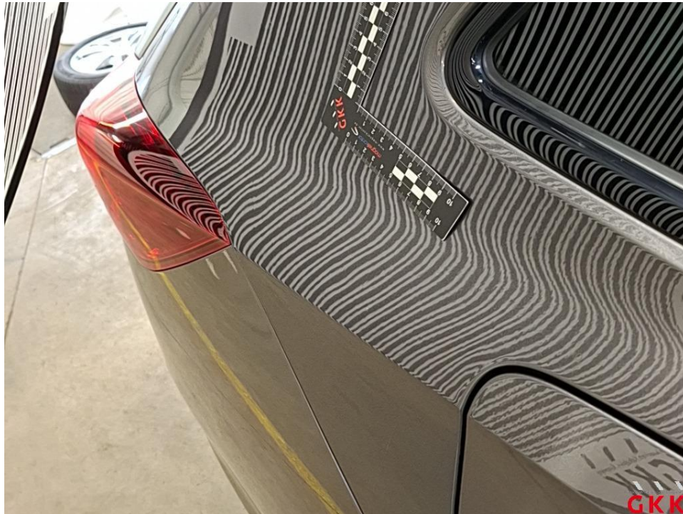
Bild 26 Seitenwand rechts, beschädigt, instand setzen - lackieren
