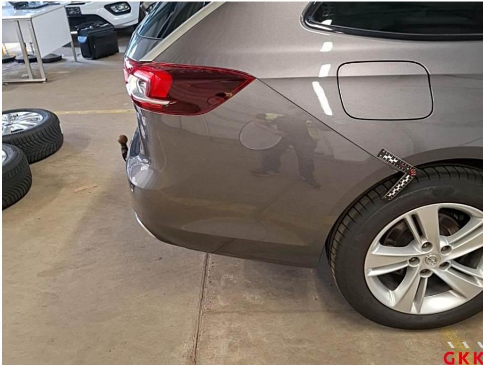
Bild 28 Stoßfänger hinten, Verkleidung -lackiert-, verkratzt, lackieren
