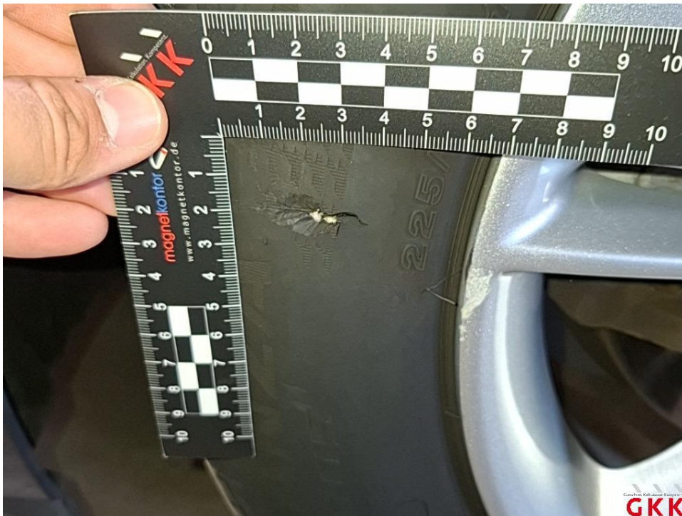
Bild 19 Reifen, vorne links, beschädigt, ersetzen
