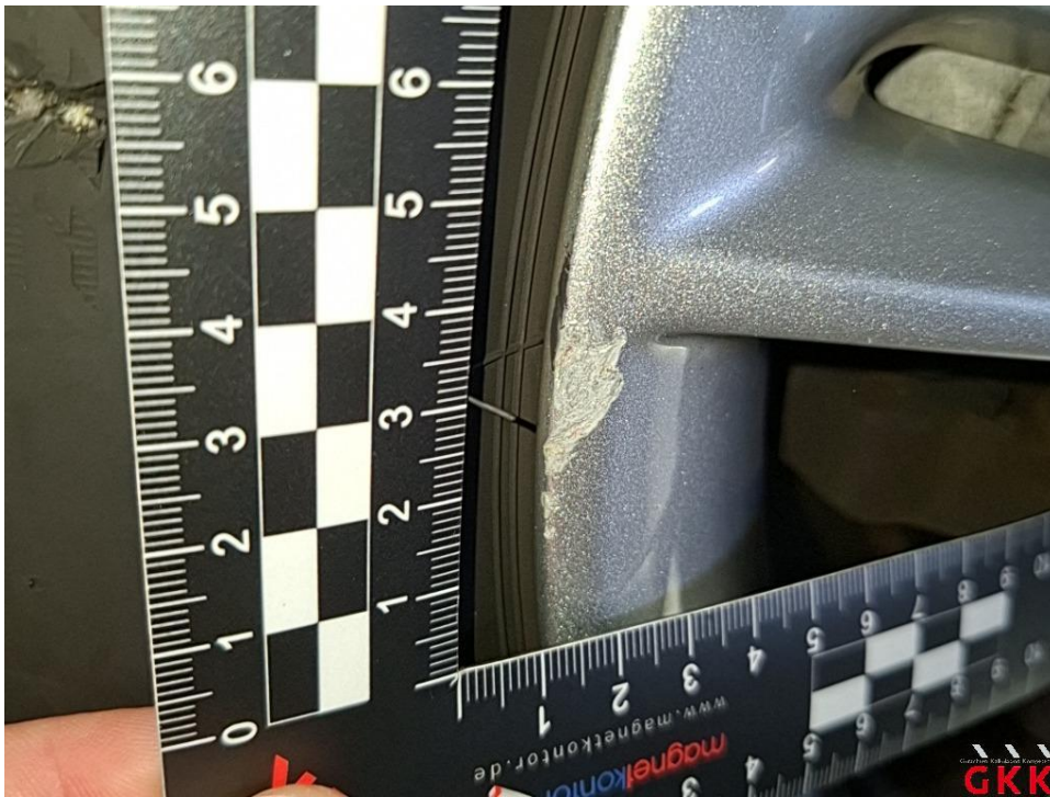
Bild 21 LM-Rad, vorne links, beschädigt, Smartrepair
