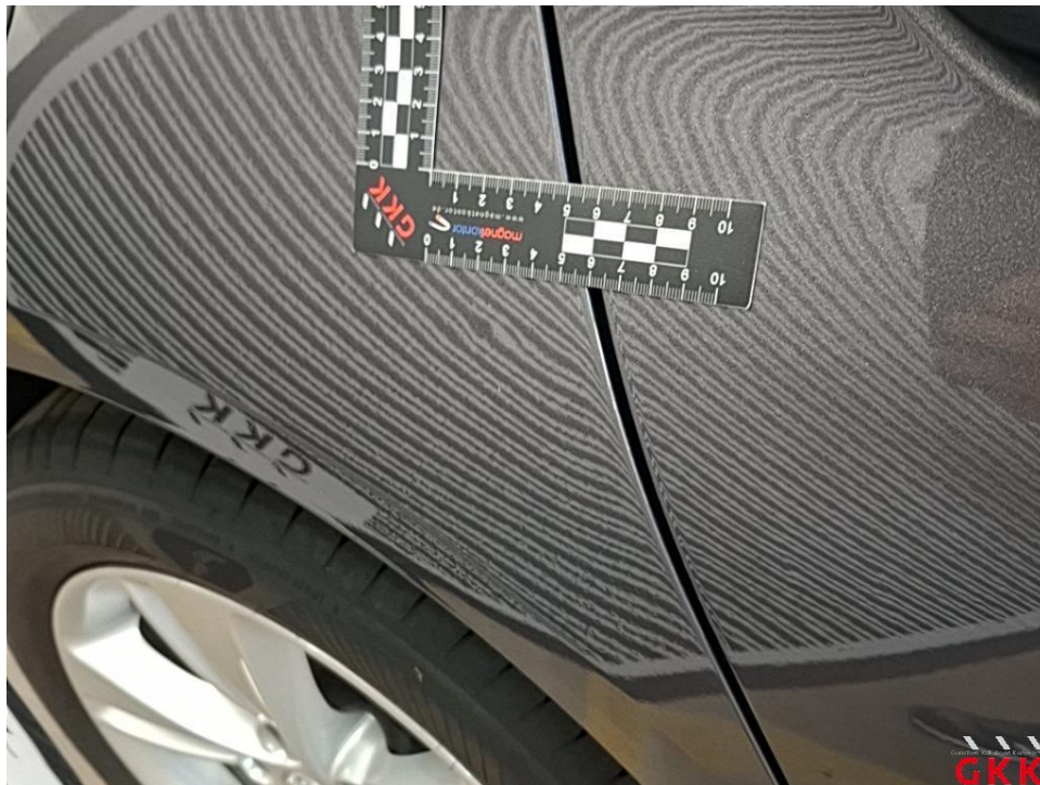
Bild 27 Seitenwand rechts, beschädigt, instand setzen - lackieren
