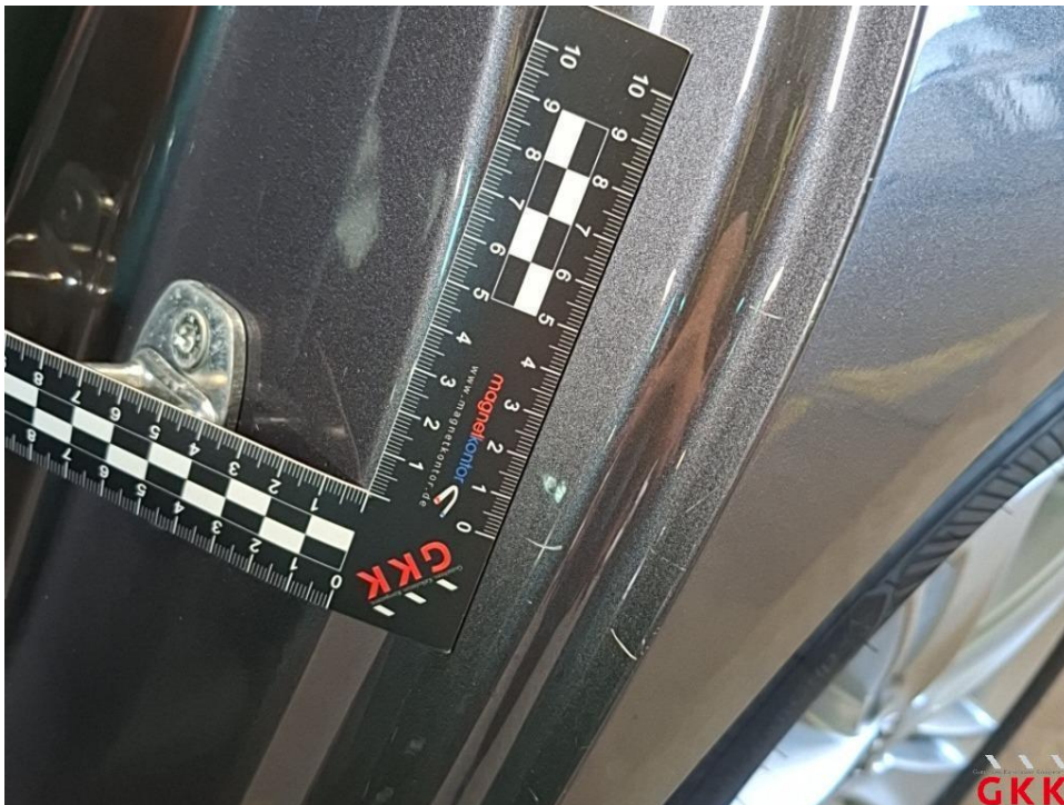
Bild 33 Seitenwand links, verkratzt, Smartrepair
