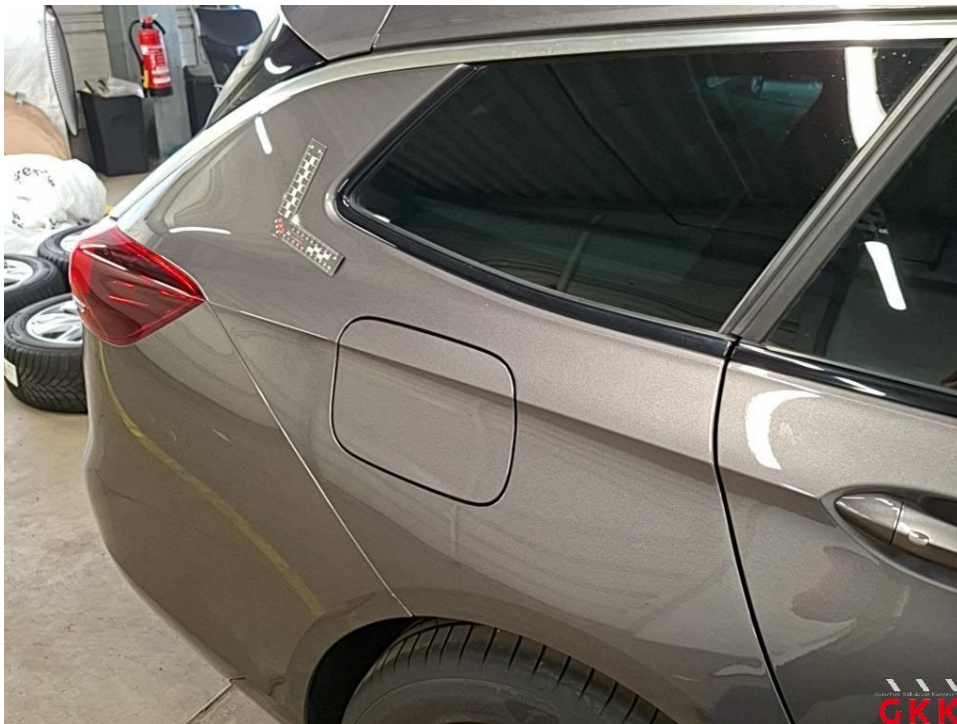
Bild 25 Seitenwand rechts, beschädigt, instand setzen - lackieren
