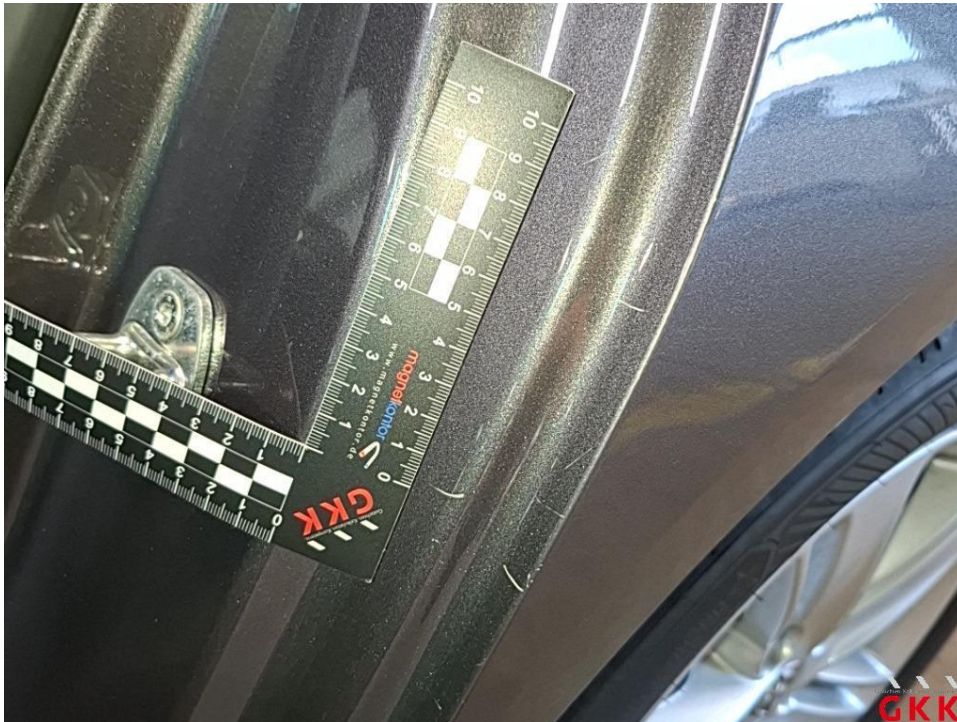
Bild 32 Seitenwand links, verkratzt, Smartrepair
