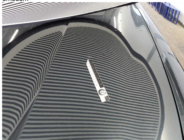
Beschädigung #14: Motorhaube: Motorhaube - Delle / Lackschaden - instandsetzen und lackieren
