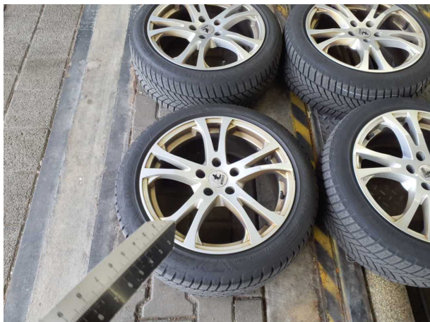
Beschädigung #1: 2.Radsatz: 1 Leichtmetallfelge - Kratzer - lackieren
