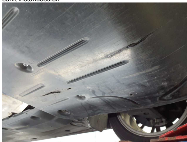
Beschädigung #3: Motor: Motorverkleidung unten - gebrochen / gerissen - erneuern
