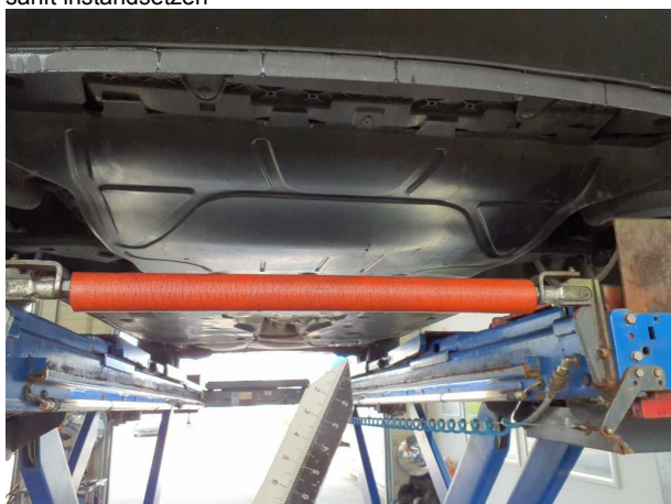
Beschädigung #3: Motor: Motorverkleidung unten - gebrochen / gerissen - erneuern
