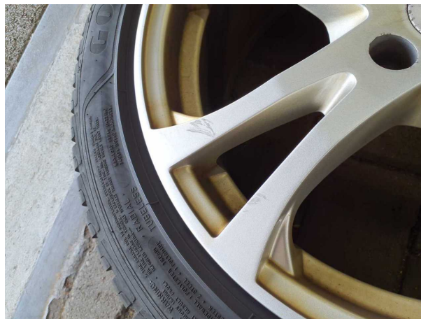
Beschädigung #1: 2.Radsatz: 1 Leichtmetallfelge - Kratzer - lackieren
