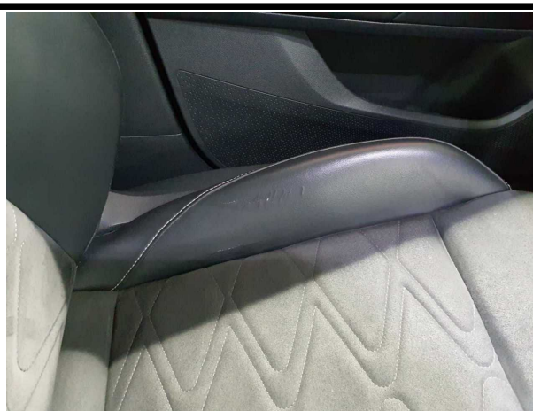
Beschädigung #13: Sitz vorn: Sitzbezug links - beschädigt - erneuern
