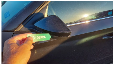
Carcasa del espejo de la puerta exterior / Izquierda / Rayado
