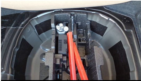
Elementos faltantes / Kit de reparación de neumáticos compresor
