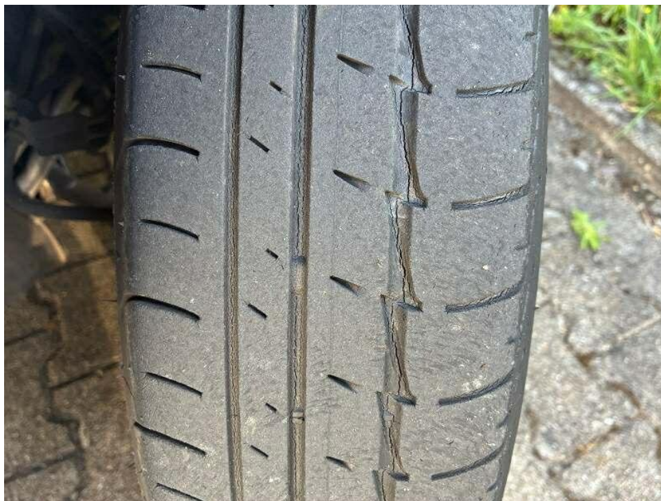
Bild 18 : Reifen VA Rissig
