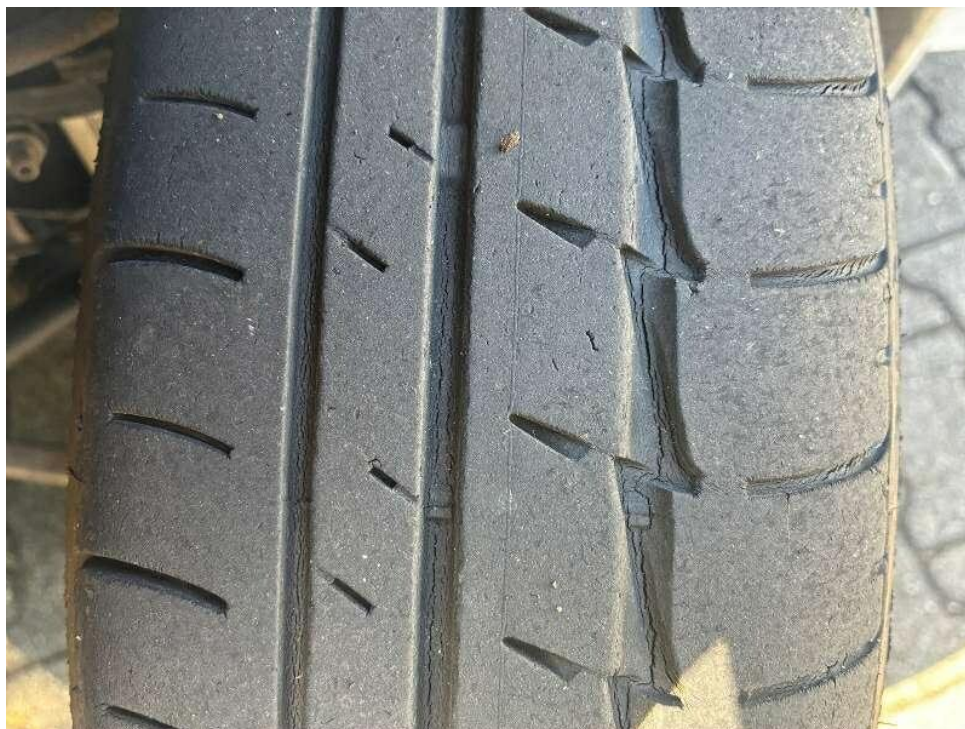
Bild 17 : Reifen VA Rissig
