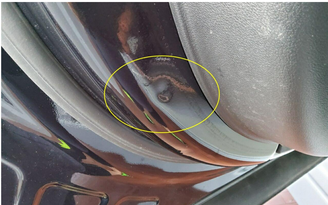
Bild 22 : Türrahmen vorne links, eingedellt, drücken
