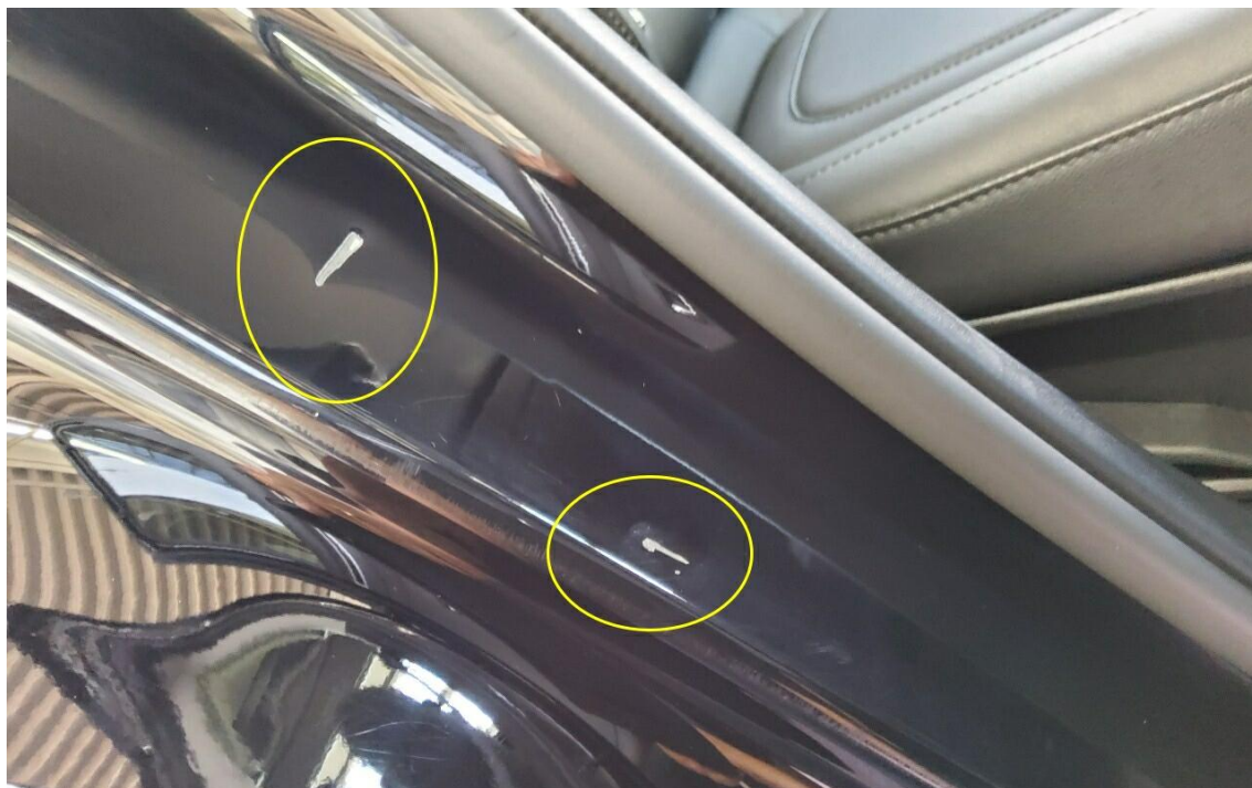
Bild 29 : Tür hinten rechts Einstieg, eingedellt, instandsetzen und lackieren mit Lackaufbau
