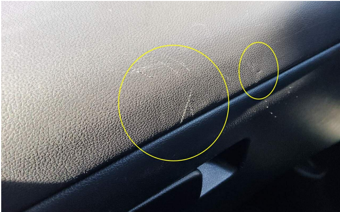
Bild 17 : Armaturenbrett rechts zerkratzt,
