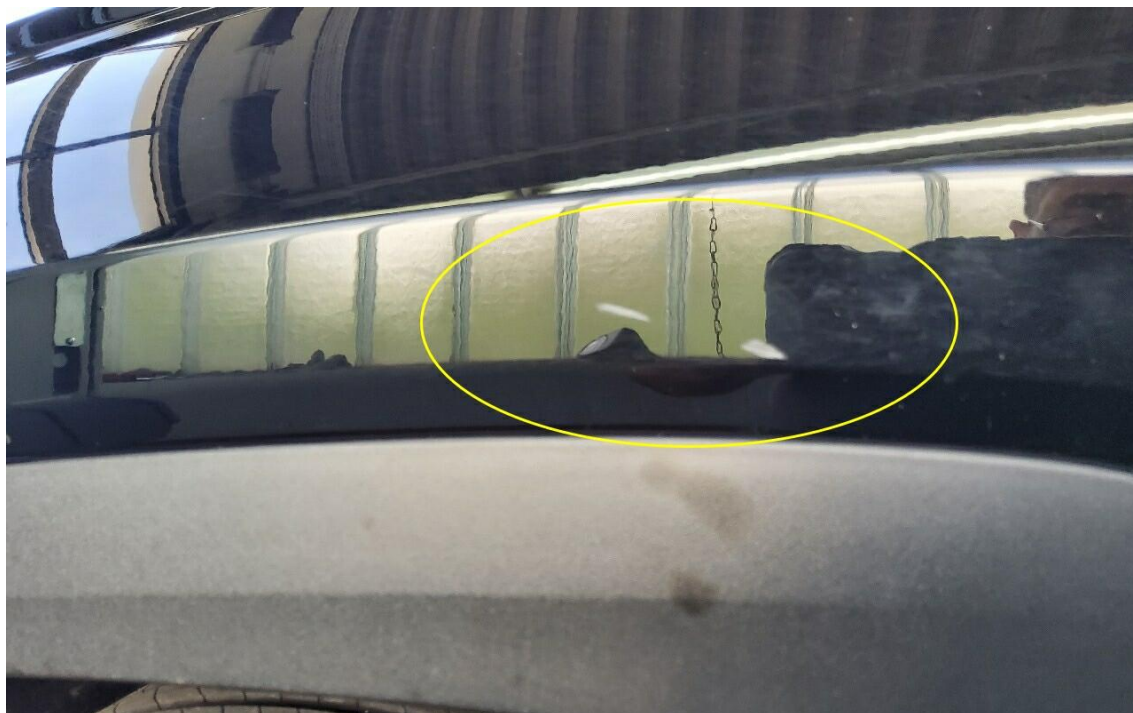
Bild 19 : Kotflügel vorne links Lackierung, fleckig, smart repair
