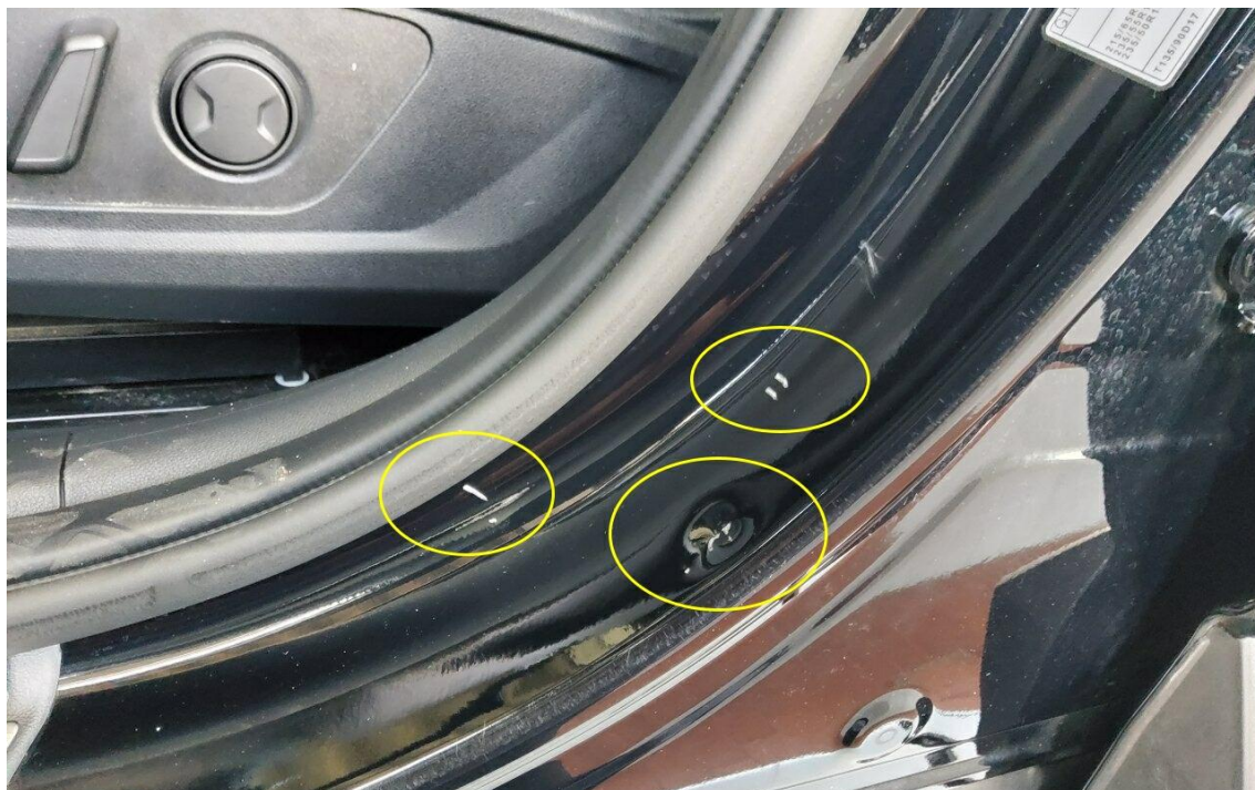
Bild 23 : Tür vorne links Einstieg, eingedellt, instandsetzen und lackieren mit Lackaufbau
