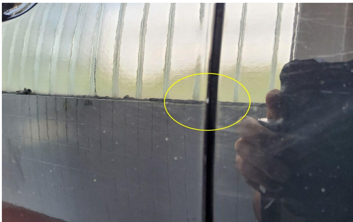
Bild 20 : Türkante vorne links zerkratzt, auslegen polieren,
