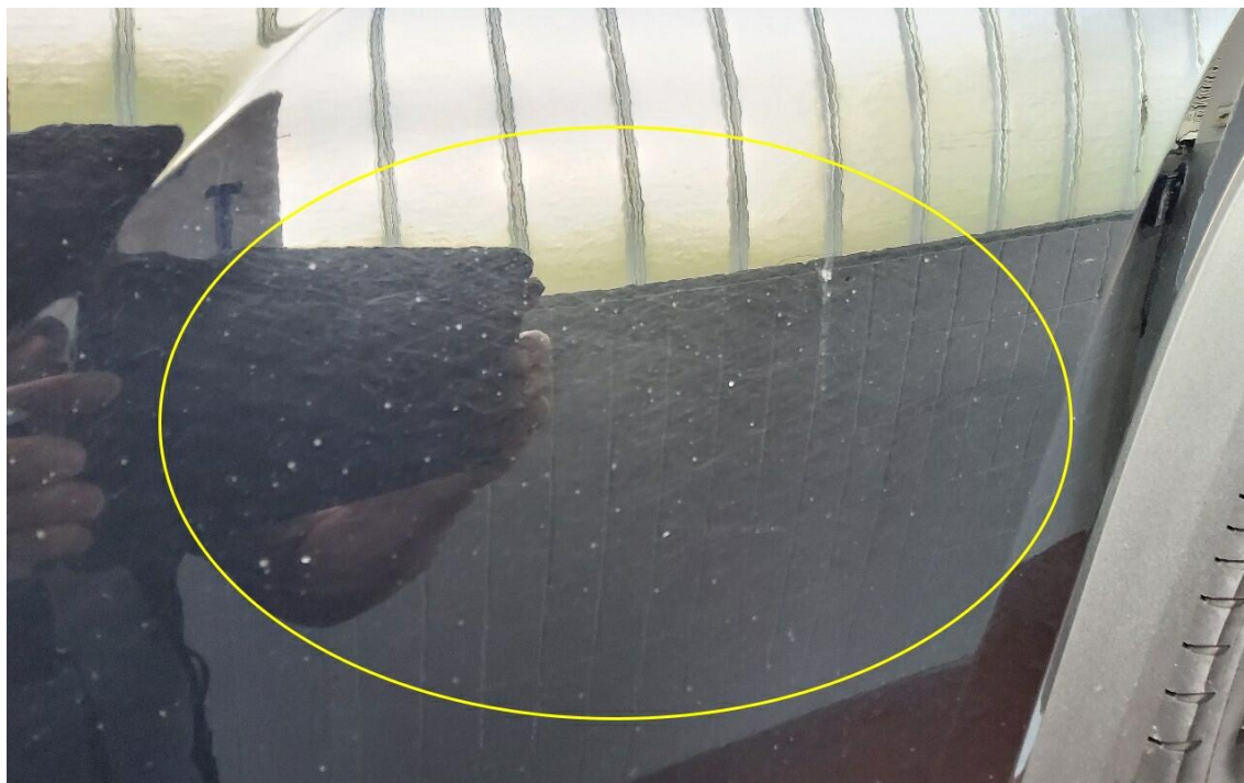
Bild 33 : Fahrzeugzeugaufbereitung, Kratzer Anhaftung,
