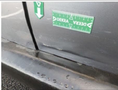
Porte / Arrière Droit / Enfoncement
