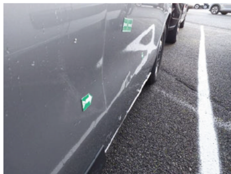
Porte / Avant Droit / Enfoncement
