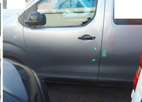
Porte / Avant Gauche / Enfoncement
