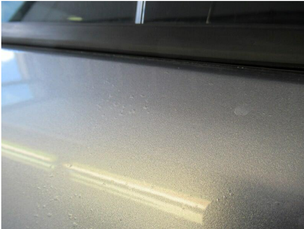
Bild 25 : Beiden Türen rechts Lackschaden: Lack hat Blasenbildungen über die gesamt Fläche.
