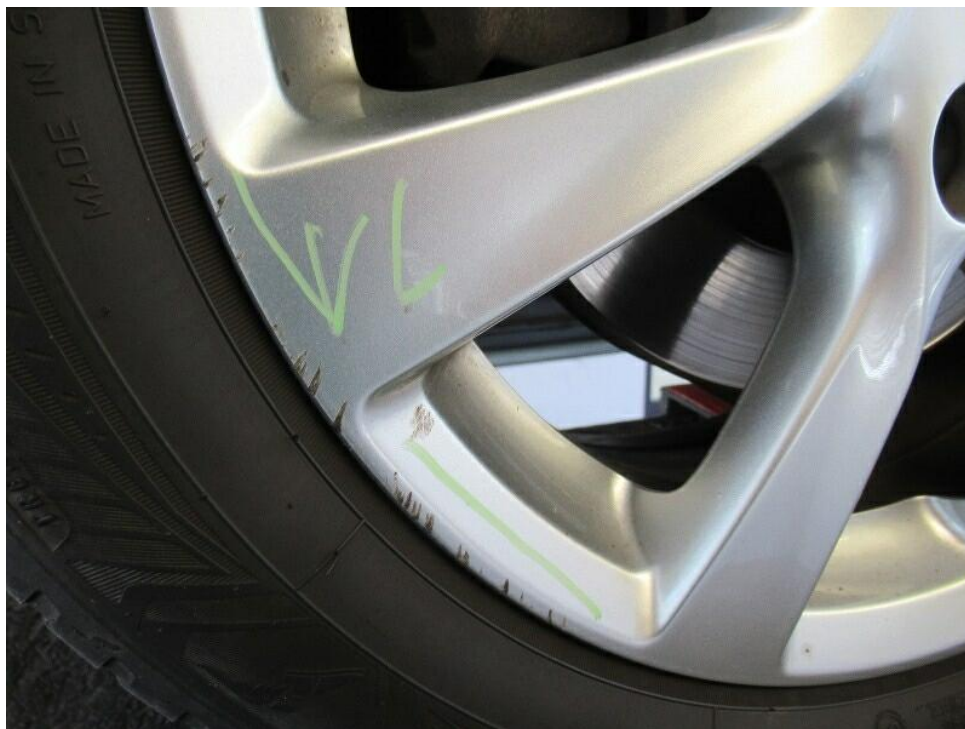
Bild 41 : Felge vorne links Lackierung, zerkratzt, smart repair
