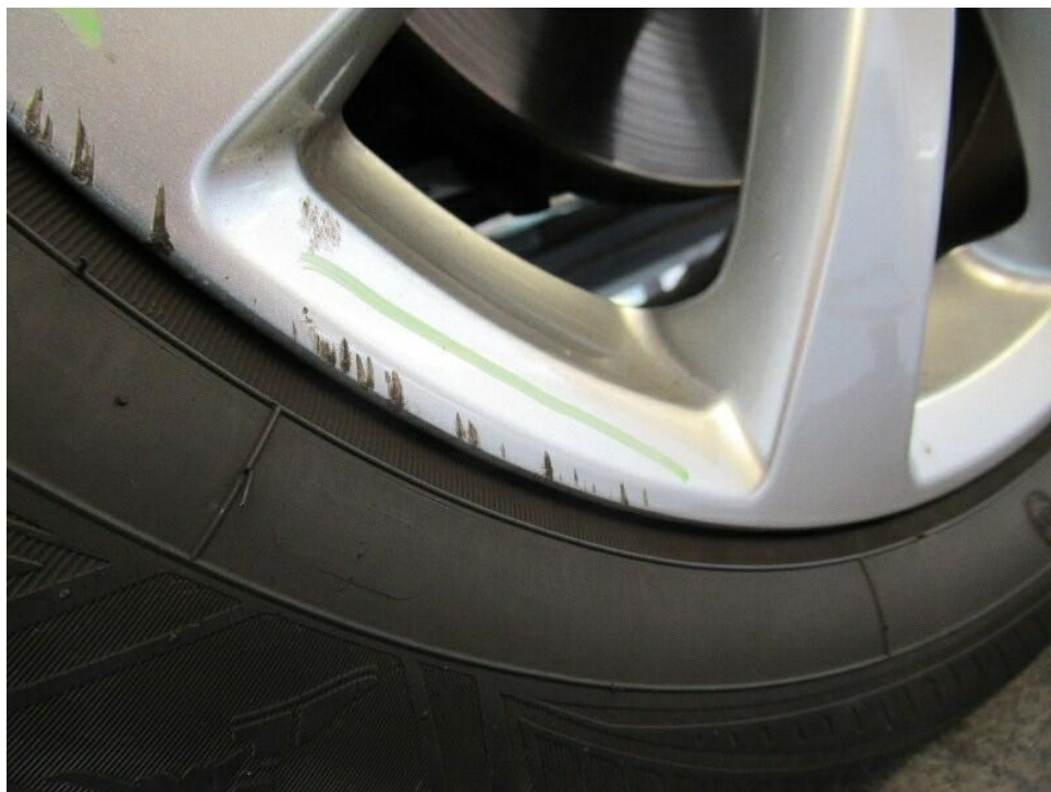
Bild 42 : Felge vorne links Lackierung, zerkratzt, smart repair
