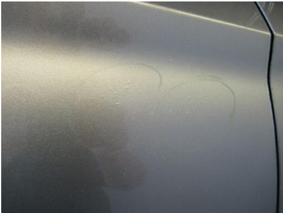
Bild 24 : Beiden Türen rechts Lackschaden: Lack hat Blasenbildungen über die gesamt Fläche.
