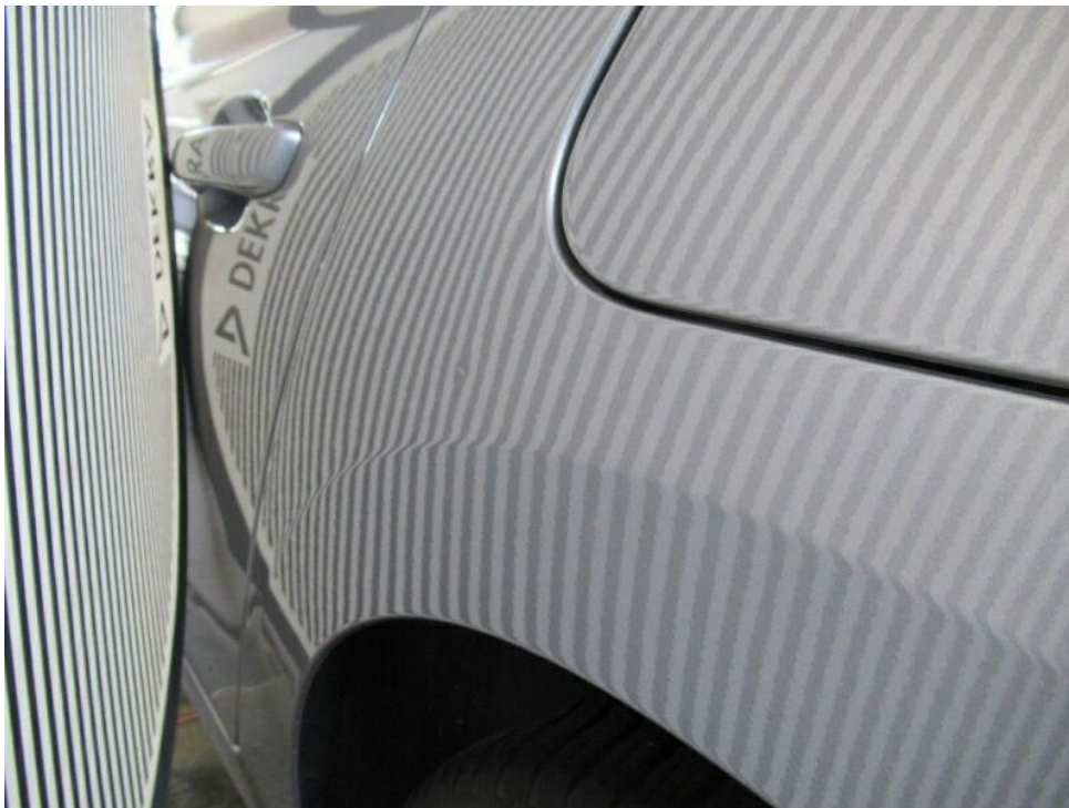
Bild 30 : Seitenteil hinten links, eingedellt, Gebrauchsspur
