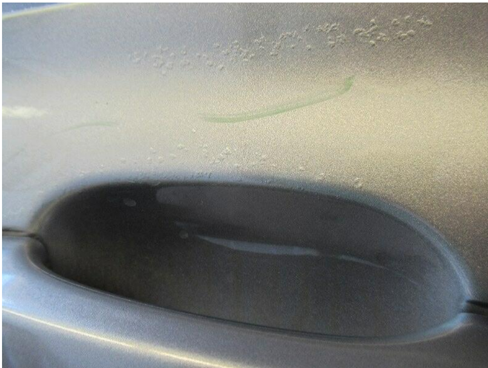
Bild 22 : Beiden Türen rechts Lackschaden: Lack hat Blasenbildungen über die gesamt Fläche.
