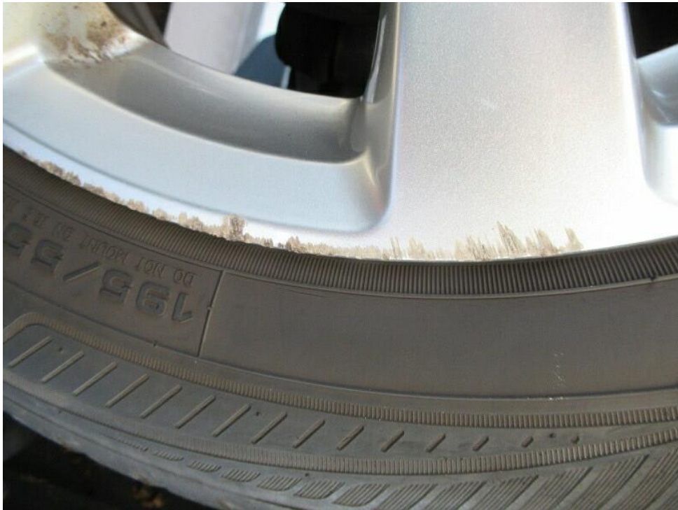
Bild 43 : Felge vorne links Lackierung, zerkratzt, smart repair
