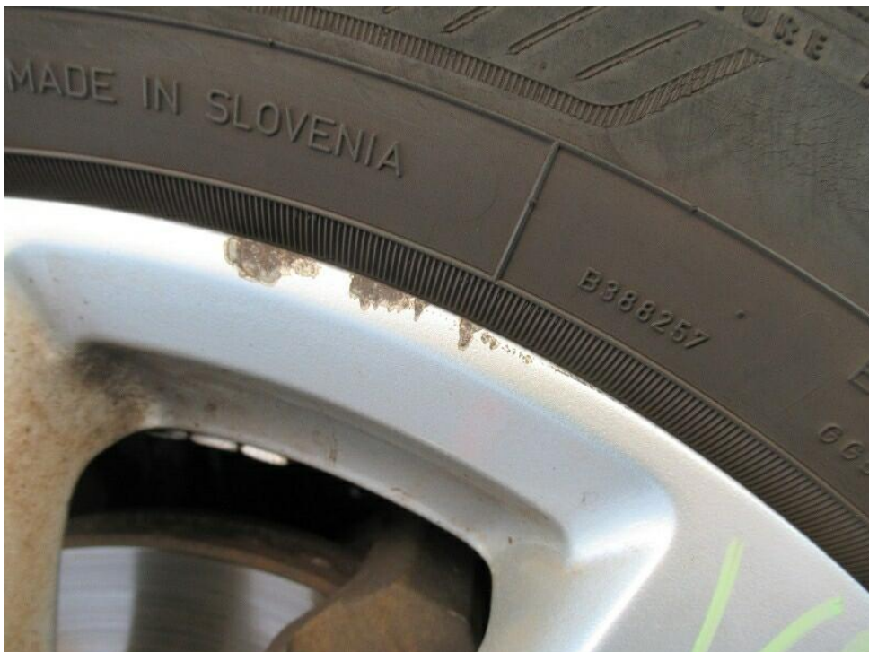
Bild 44 : Felge vorne rechts Lackierung, zerkratzt, smart repair
