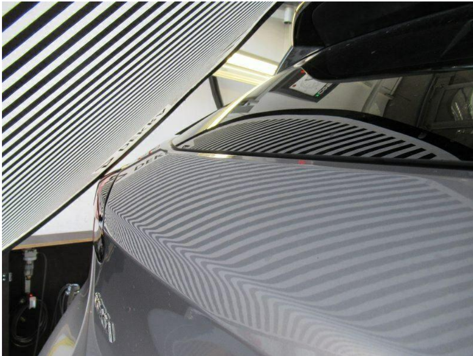
Bild 29 : Heckdeckel, eingedellt, Gebrauchsspur
