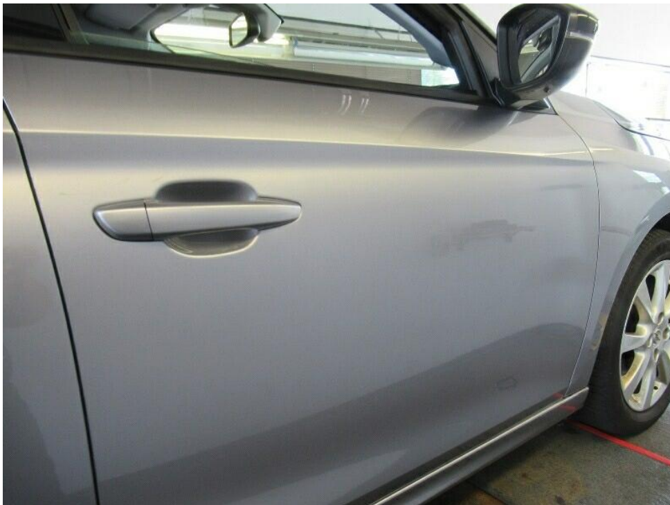
Bild 26 : Beiden Türen rechts Lackschaden: Lack hat Blasenbildungen über die gesamt Fläche.
