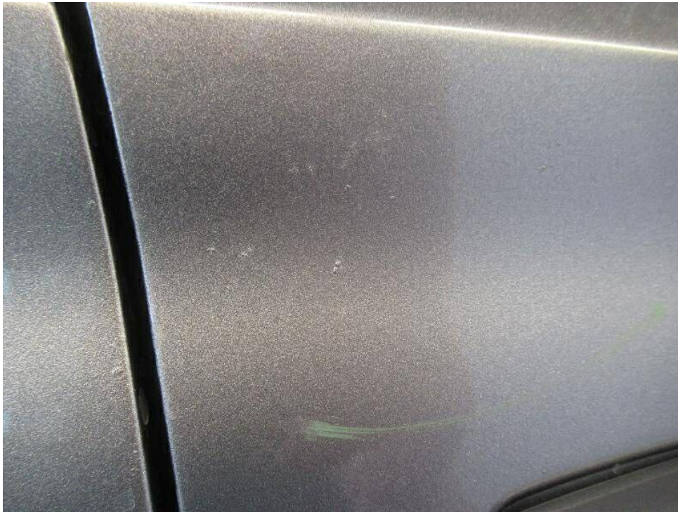
Bild 27 : Beiden Türen rechts Lackschaden: Lack hat Blasenbildungen über die gesamt Fläche.
