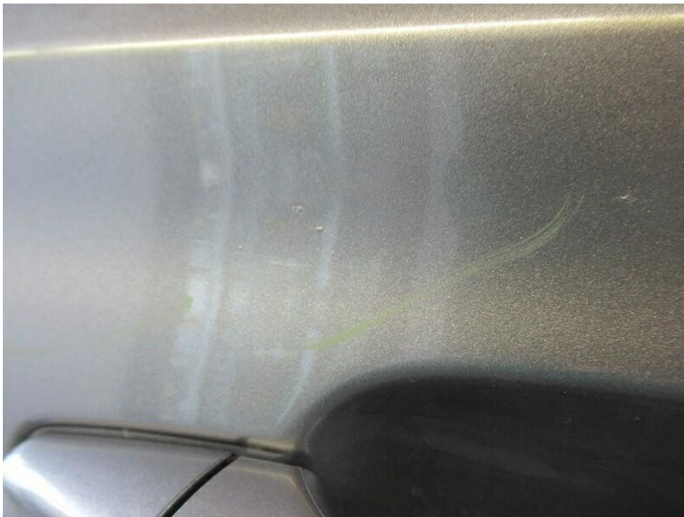
Bild 28 : Beiden Türen rechts Lackschaden: Lack hat Blasenbildungen über die gesamt Fläche.
