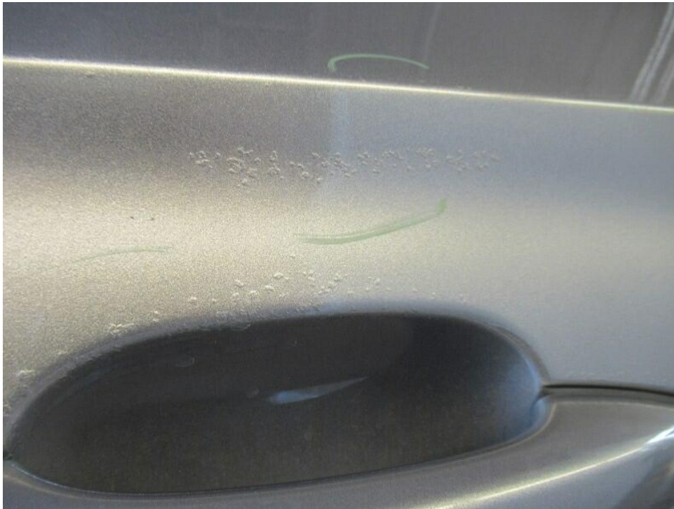
Bild 21 : Beiden Türen rechts Lackschaden: Lack hat Blasenbildungen über die gesamt Fläche.
