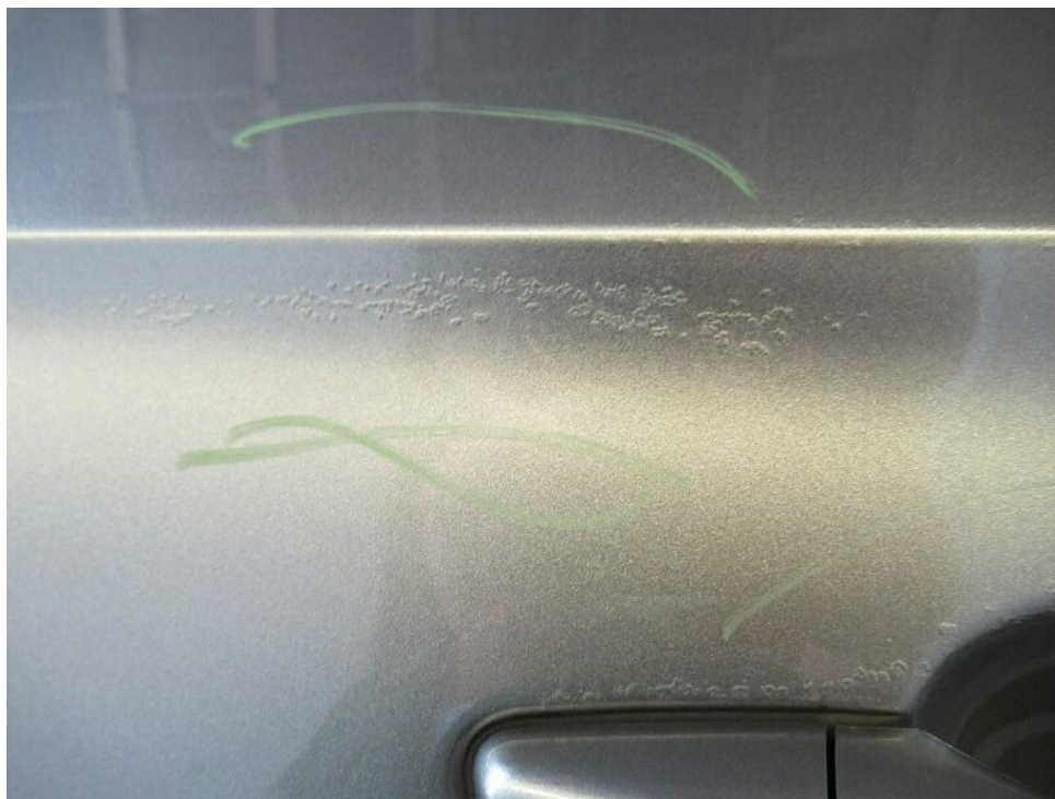
Bild 20 : Beiden Türen rechts Lackschaden: Lack hat Blasenbildungen über die gesamt Fläche.
