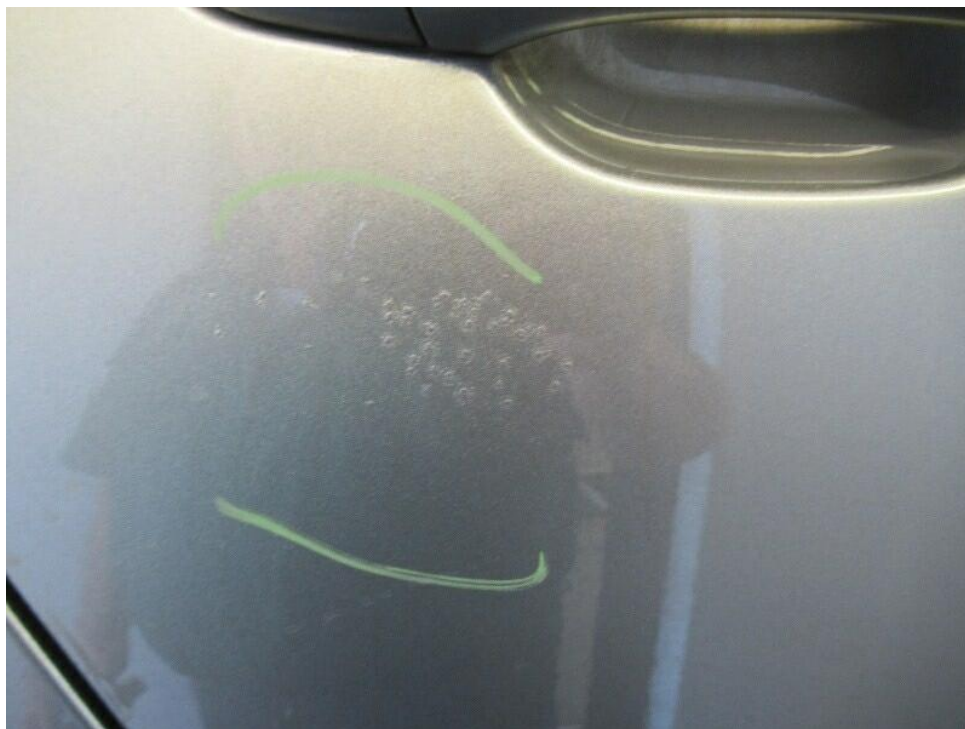
Bild 19 : Beiden Türen rechts Lackschaden: Lack hat Blasenbildungen über die gesamt Fläche.
