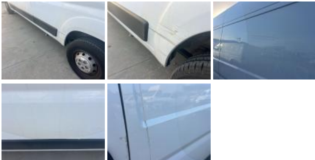
Door FL, Scratch(es), Paint
