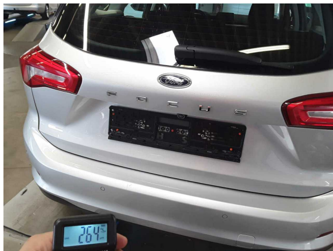
Boot lid / rear door: 264 µm
