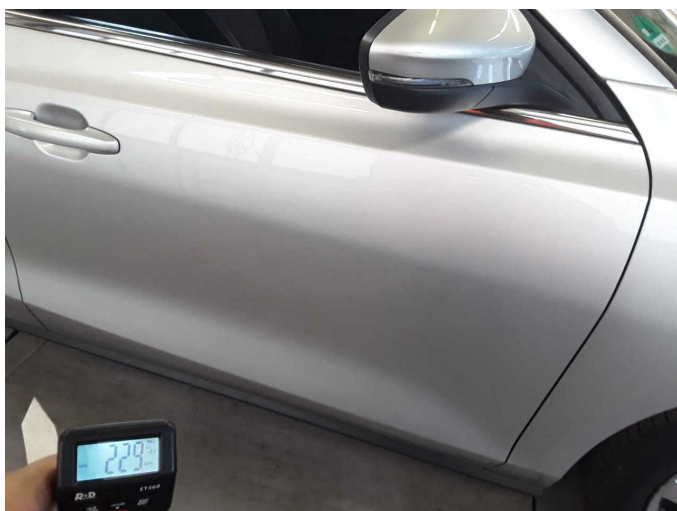
Door - front right side: 229 µm
