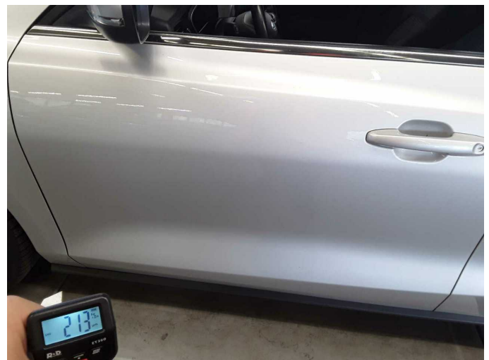
Door - front left side: 213 µm
