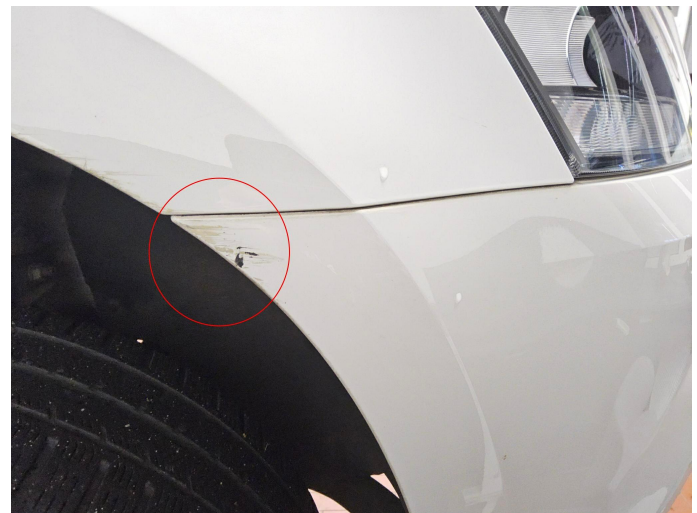
Bild 16: Außen, Stoßfänger vorne - Lackierung, zerkratzt, smart repair
