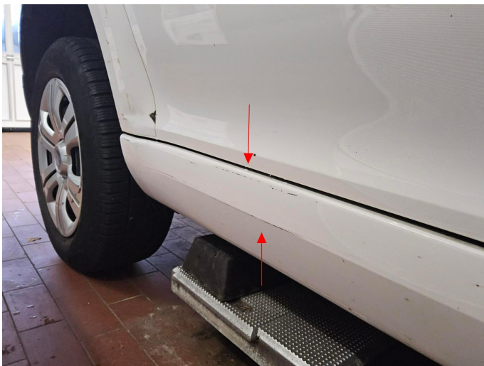
Bild 7: Außen, Seitenschweller rechts - Lackierung, zerkratzt, lackieren
