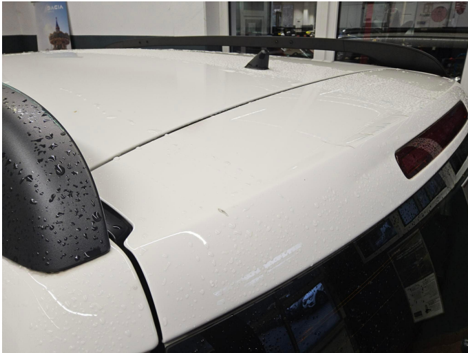
Bild 5: Außen, Dach, Unfall zerkratzt eingedellt , Gutachten erforderlich Kostenerweiterung möglich
