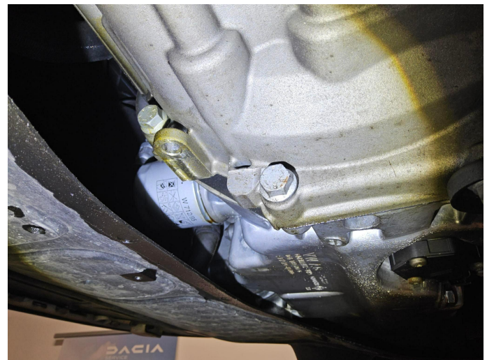
Bild 20: Technik, Motor, undicht, prüfen und Befund festlegen, Schaden- erweiterung möglich
