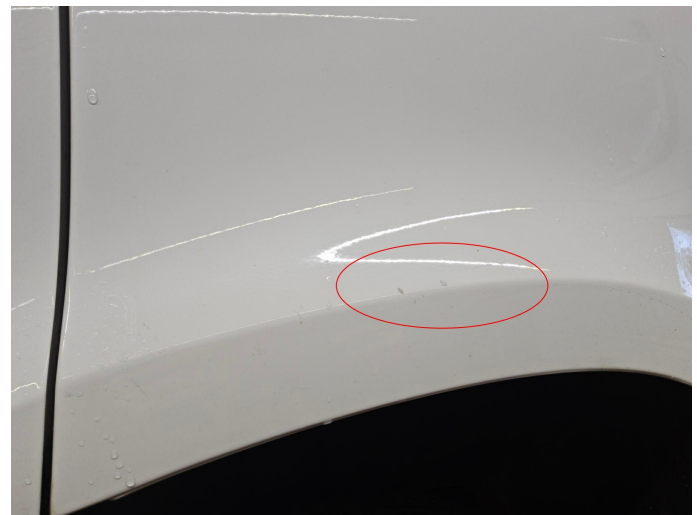
Bild 12: Außen, Seitenteil hinten links - Lackierung, zerkratzt, smart repair
