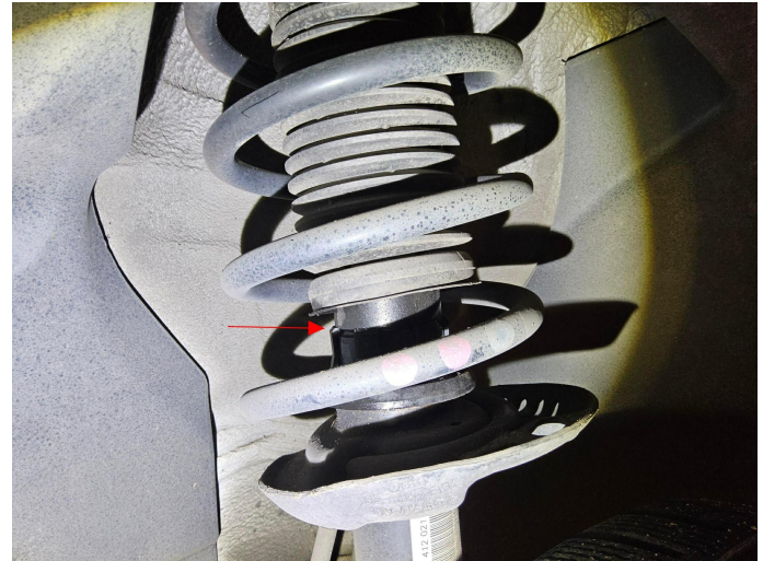
Bild 22: Technik, Vorderachse - Stoßdämpfer vorne links , undicht, erneuern
