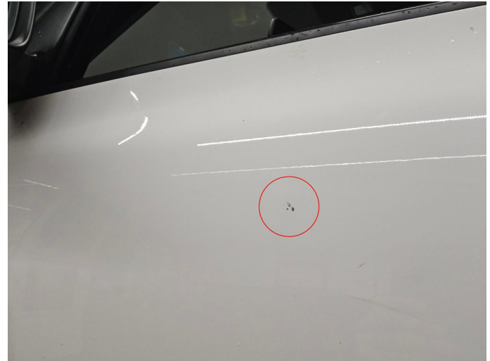
Bild 10: Außen, Tür vorne links - Lackierung, zerkratzt, polieren Schadenerweiterung möglich
