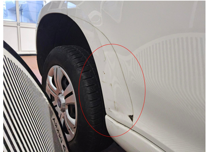
Bild 6: Außen, Tür hinten rechts, Unfallschaden deformiert , Gutachten erforderlich Kostenerweiterung möglich
