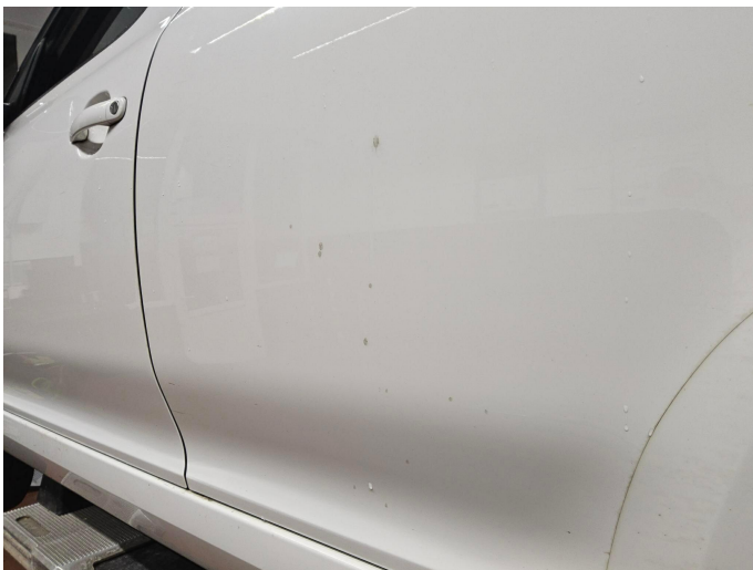
Bild 11: Außen, Tür hinten links - Lackierung, fleckig, polieren Schadenerweiterung möglich
