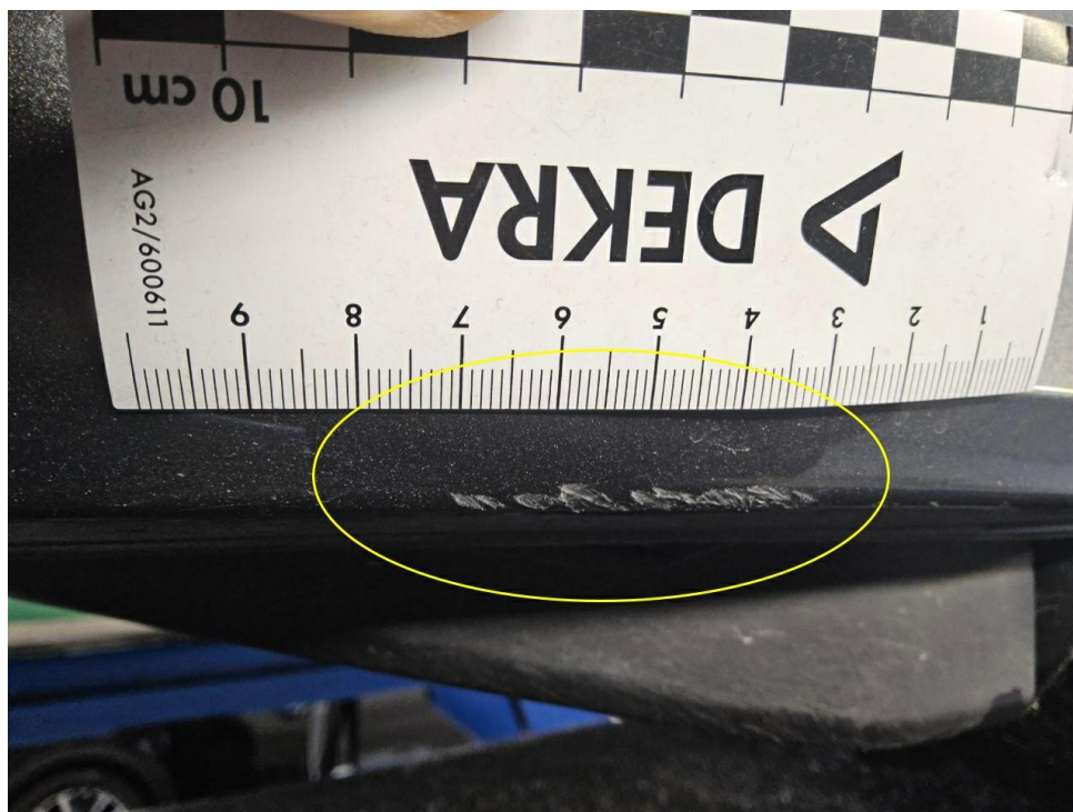
Bild 21 : Frontspoiler Lackierung, verschrammt, lackieren mit Lackaufbau
