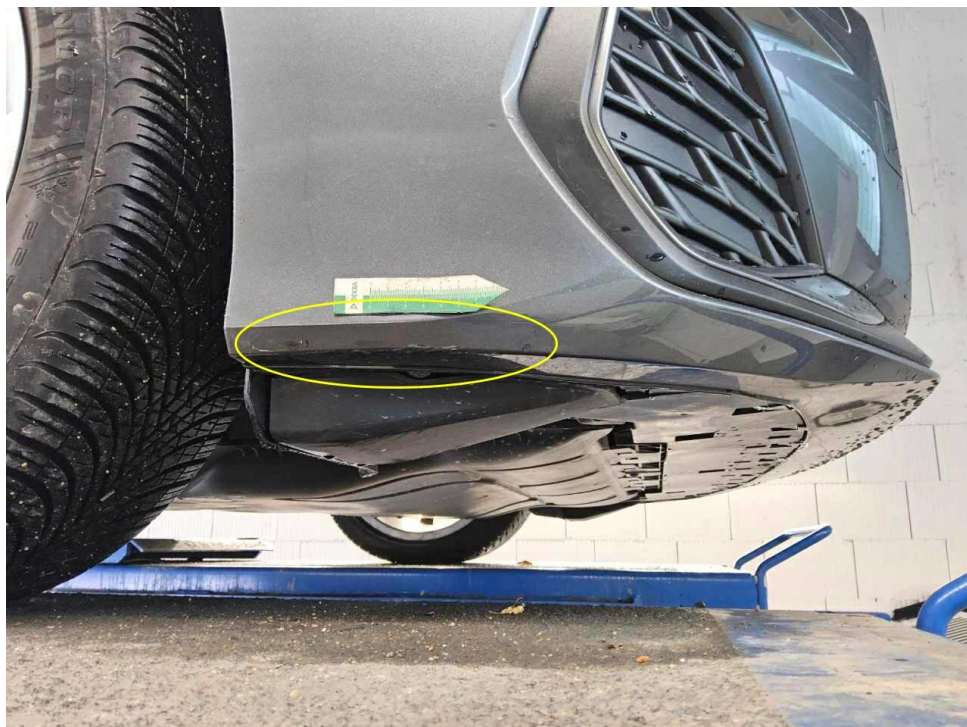
Bild 18 : Frontspoiler Lackierung, verschrammt, lackieren mit Lackaufbau
