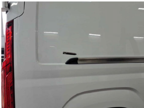
Beschädigung #4: Seitenwand rechts: Seitenwand (Folgekosten möglich) - Korrosion - Smart Repair
