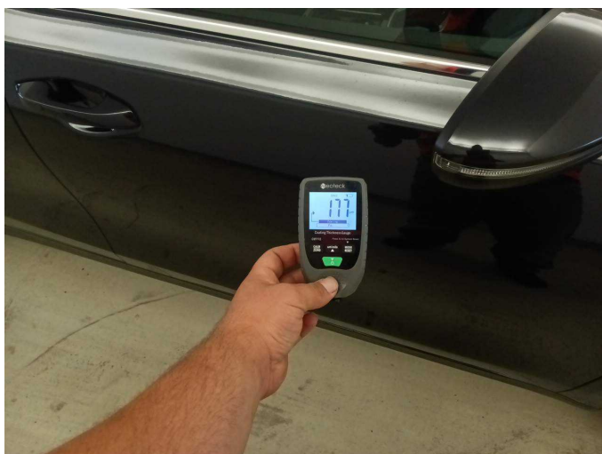
Door - front right side: 177 µm
