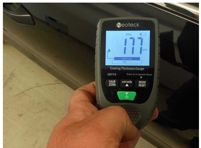
Door - front right side: 177 µm
