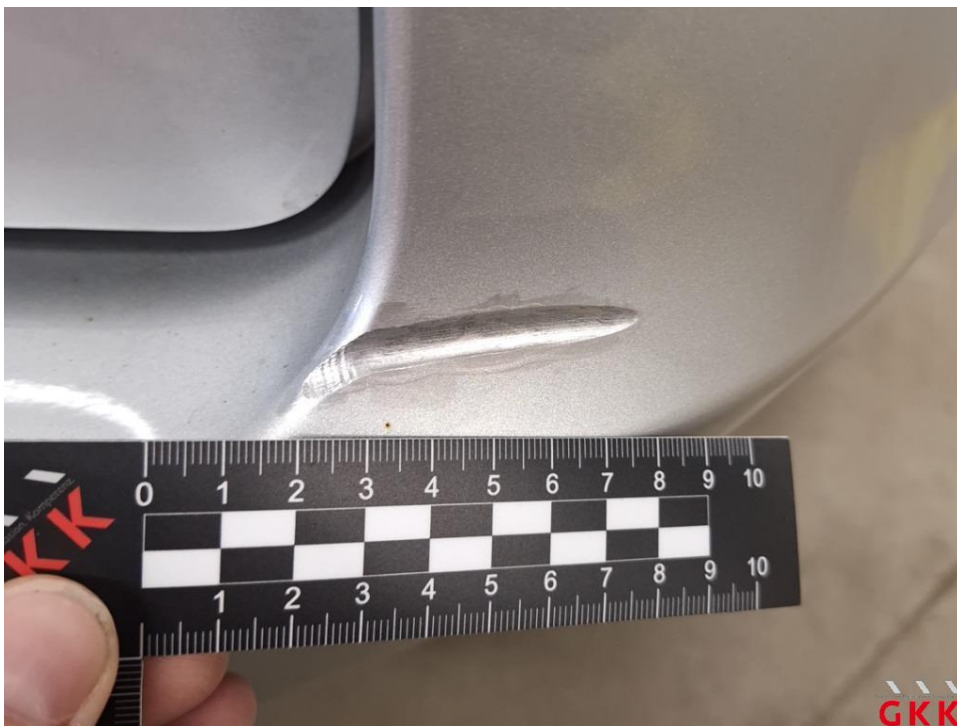
Bild 18 Stoßfänger hinten, Ecke rechts -lackiert-, beschädigt, ersetzen
