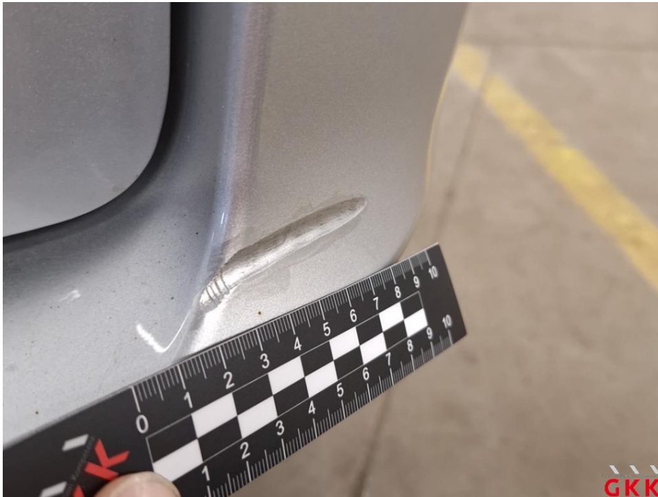
Bild 19 Stoßfänger hinten, Ecke rechts -lackiert-, beschädigt, ersetzen
