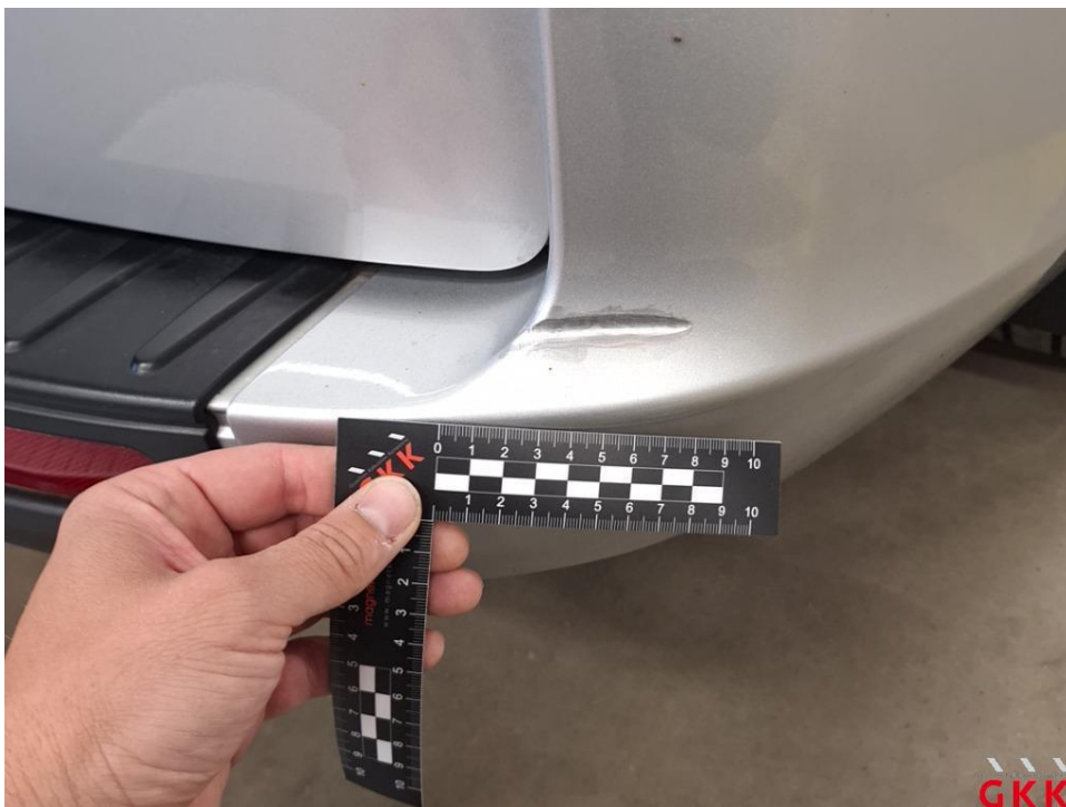
Bild 17 Stoßfänger hinten, Ecke rechts -lackiert-, beschädigt, ersetzen
