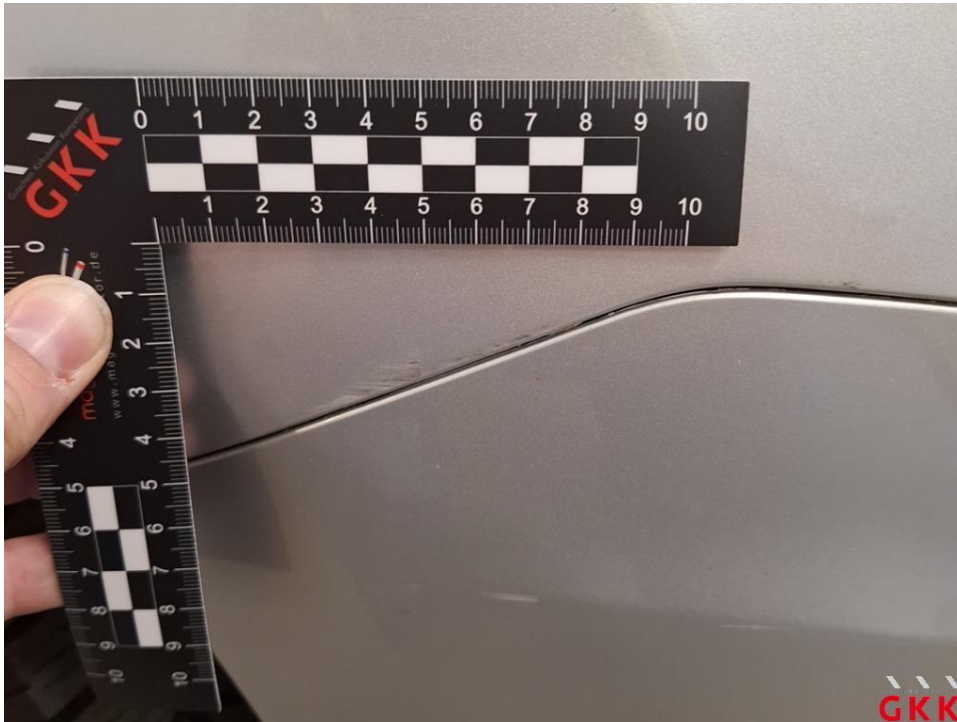
Bild 15 Stoßfänger vorne, Verkleidung -lackiert-, verkratzt, Smartrepair
