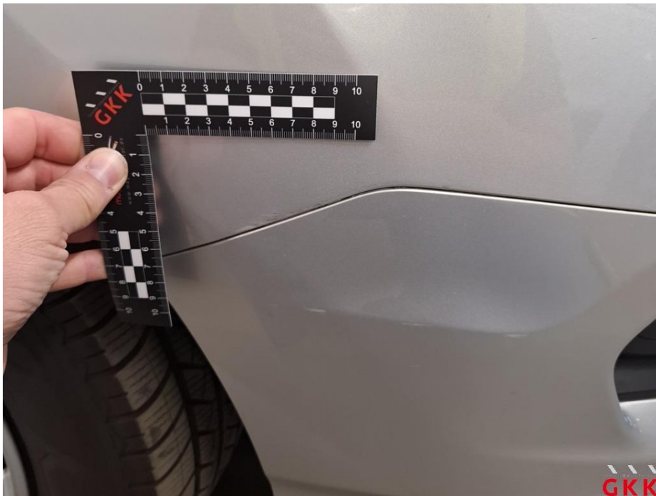
Bild 14 Stoßfänger vorne, Verkleidung -lackiert-, verkratzt, Smartrepair
