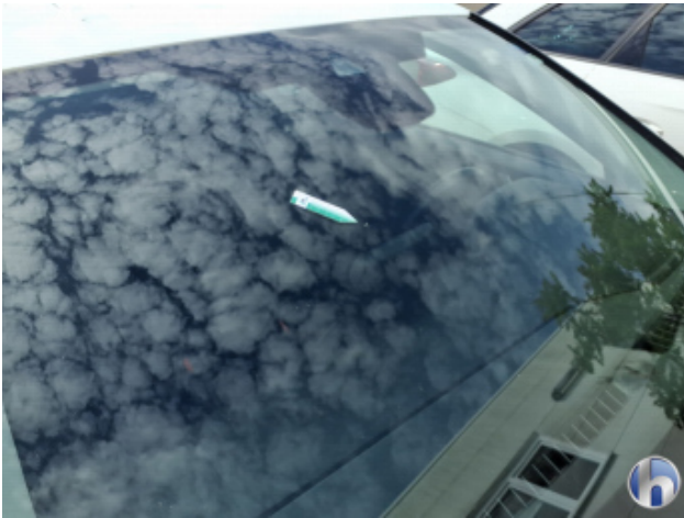
2. Windschutzscheibe Steinschlag - Smart Repair
