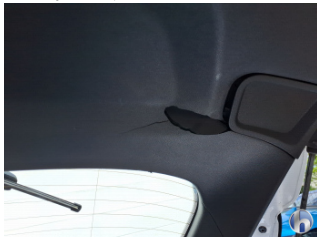
3. Heckdeckelverkleidung Beschädigt - Erneuern
