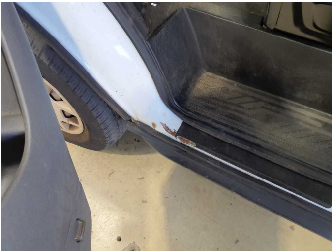
Damage 10: Door - front left side: Door seal - Broken / torn - Replace
