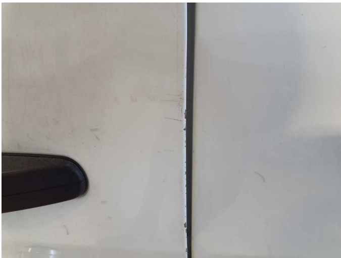
Damage 16: Door - front left side: Door (teilweise) - Dent / paintcoat damage - Smart repair
