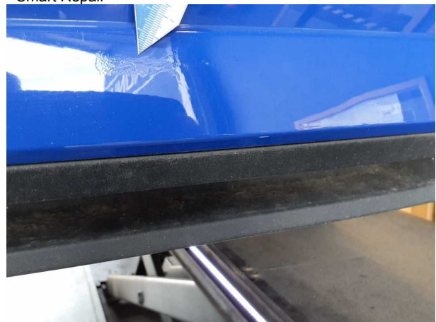
Beschädigung #4: Stossfänger hinten: Stossfänger hinten - nicht fachgerecht instandgesetzt - lackieren
