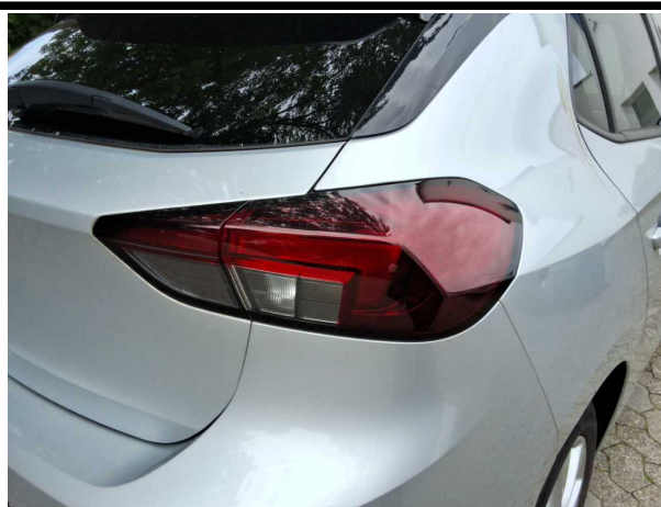
Beschädigung #4: Stossfänger hinten: Rückstrahler rechts - Kratzer - erneuern
