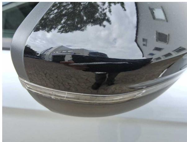
Beschädigung #1: Außenspiegel rechts: Abdeckkappe - Kratzer - Smart Repair
