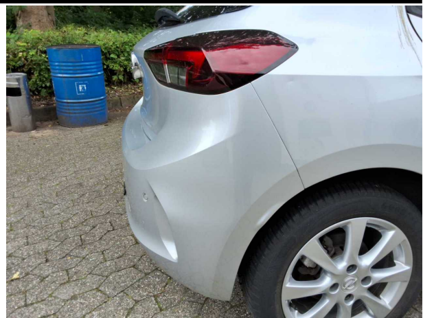
Beschädigung #7: Stossfänger hinten: Stossfänger hinten - Kratzer - lackieren
