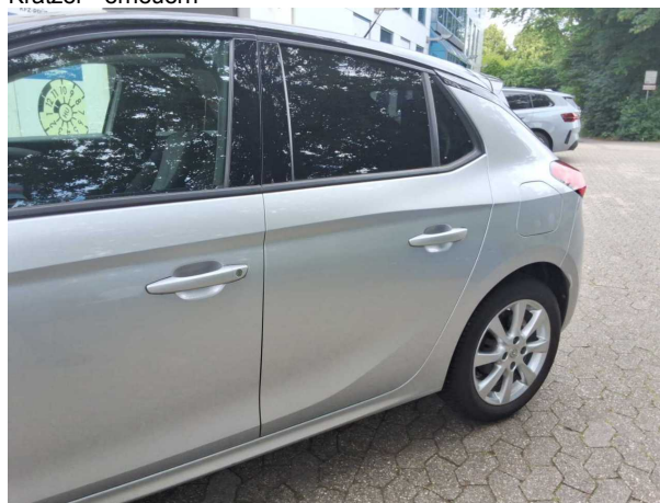
Beschädigung #6: Tür hinten links: Tür - Kratzer - lackieren
