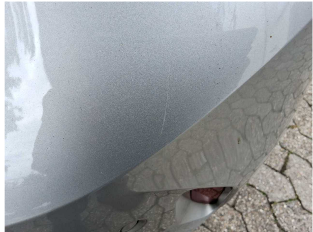
Beschädigung #7: Stossfänger hinten: Stossfänger hinten - Kratzer - lackieren
