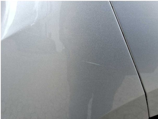
Beschädigung #7: Stossfänger hinten: Stossfänger hinten - Kratzer - lackieren
