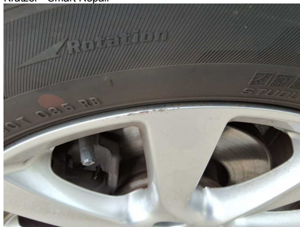
Beschädigung #2: Rad/Reifen: Leichtmetallfelge vorn links - Kratzer - erneuern
