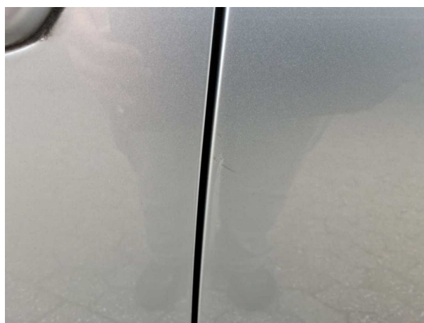
Beschädigung #6: Tür hinten links: Tür - Kratzer - lackieren
