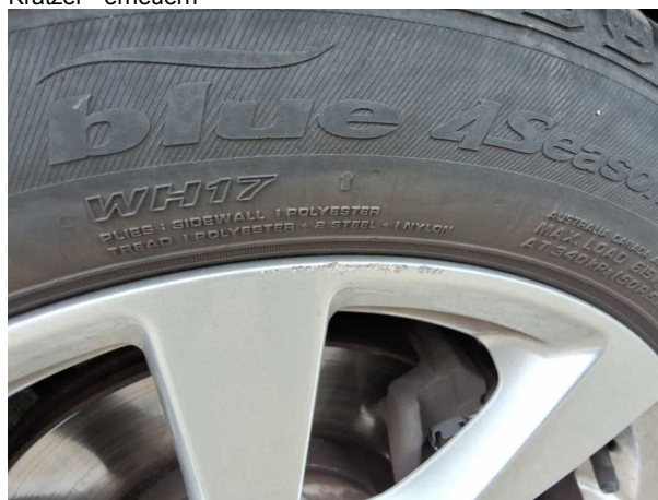
Beschädigung #3: Rad/Reifen: Leichtmetallfelge vorn rechts - Kratzer - erneuern
