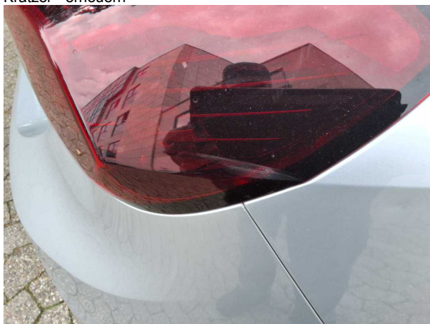
Beschädigung #4: Stossfänger hinten: Rückstrahler rechts - Kratzer - erneuern
