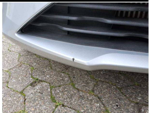
Beschädigung #9: Stossfänger vorn: Stossfänger vorn - Kratzer - lackieren
