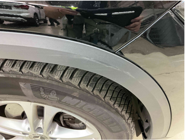
Vorderseite Beifahrerseite Kotflugel Kratzer Austausch
