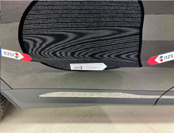
Tur hinten rechts Kratzer Vollständige Lackierung 400€
