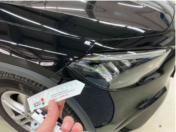
Front Scheinwerfer Rechts Kratzer Austausch
