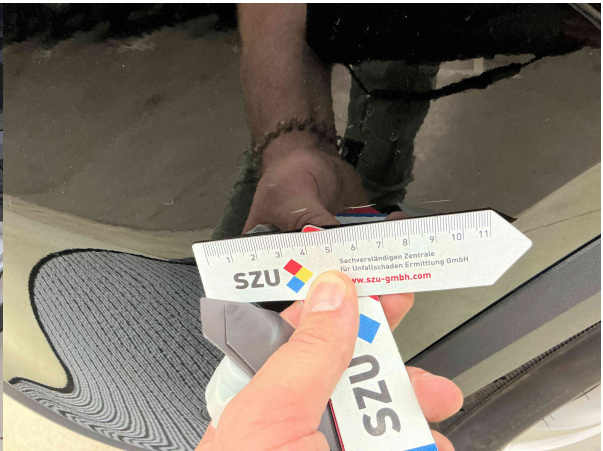
Stossfanger hinten Kratzer Teilweise Lackierung 350€
