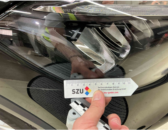
Front Scheinwerfer Rechts Kratzer Austausch
