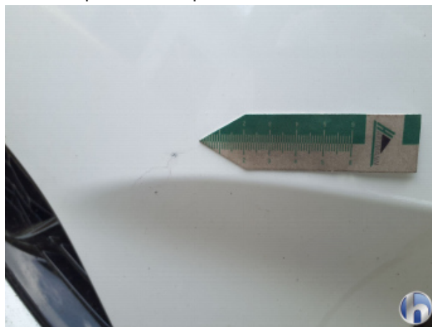
5. Stoßfänger Vorne Beschädigt - Instandsetzen und Lackieren
