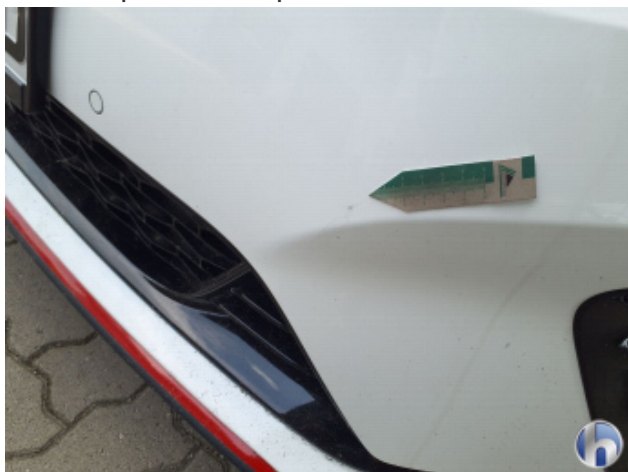
5. Stoßfänger Vorne Beschädigt - Instandsetzen und Lackieren
