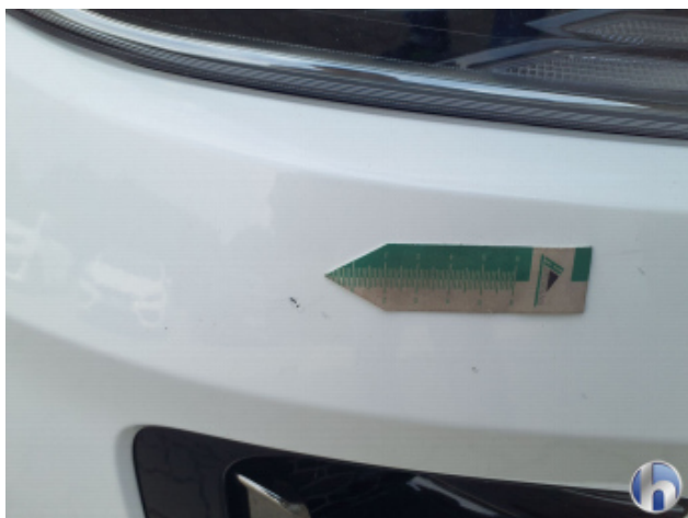
5. Stoßfänger Vorne Beschädigt - Instandsetzen und Lackieren
