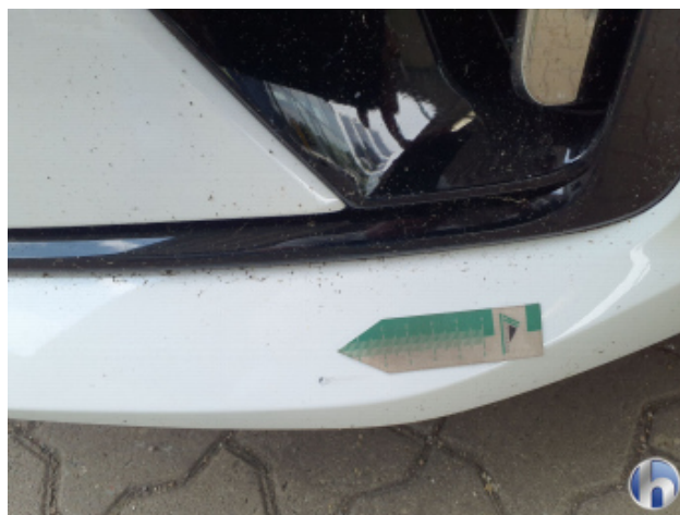
5. Stoßfänger Vorne Beschädigt - Instandsetzen und Lackieren
