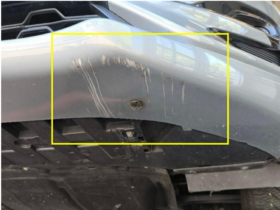
Bild 15 : Stoßfänger vorne Lackierung, zerkratzt, smart repair
