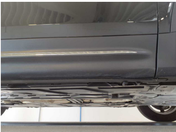
Damage 6: Door - front right side: Door (Verkleidung unten) - Scratch(es) - Replace
