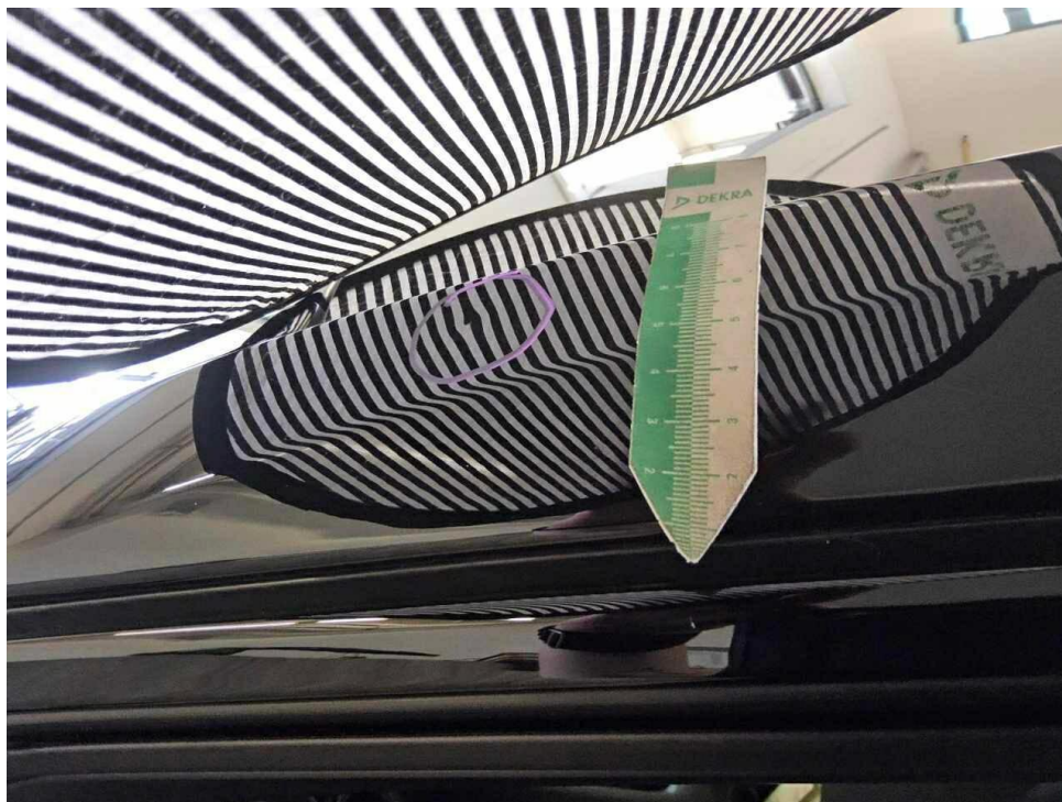
Bild 29 : Dachrahmen links, eingedellt, drücken
