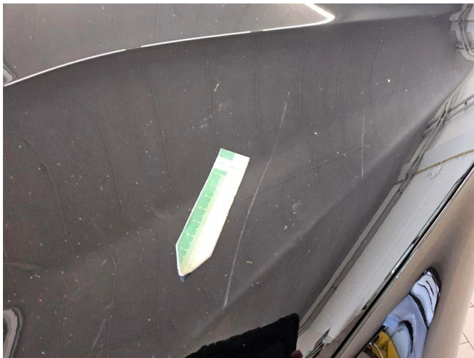
Bild 25 : Motorhaube Lackierung, verschrammt, Gebrauchsspur
