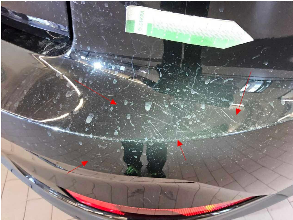
Bild 19 : Stoßfänger vorne Lackierung, verschrämmt, Gebrauchsspur
