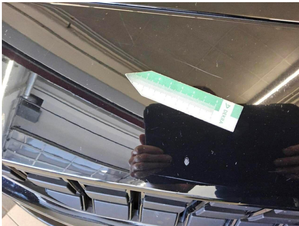
Bild 27 : Stoßfänger vorne Lackierung, verschrammt, Gebrauchsspur
