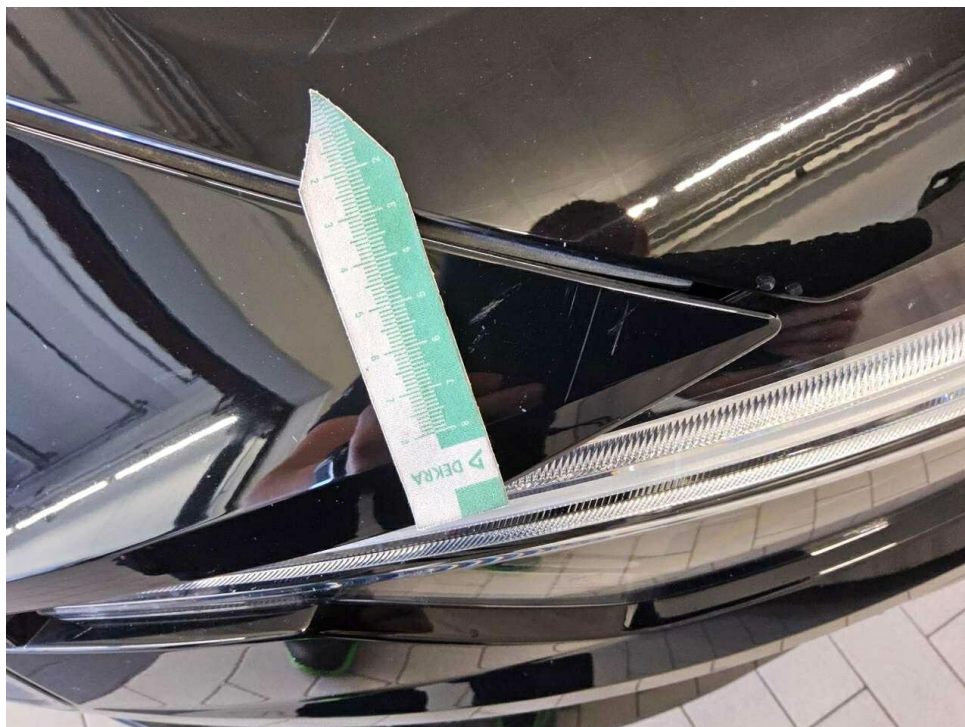
Bild 28 : Stoßfänger vorne Lackierung, verschrammt, Gebrauchsspur
