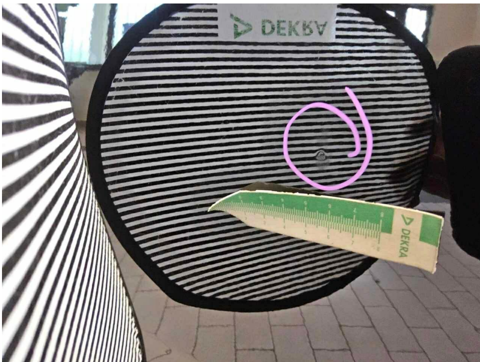
Bild 20 : Tür hinten rechts Lackfehler und Kratzer
