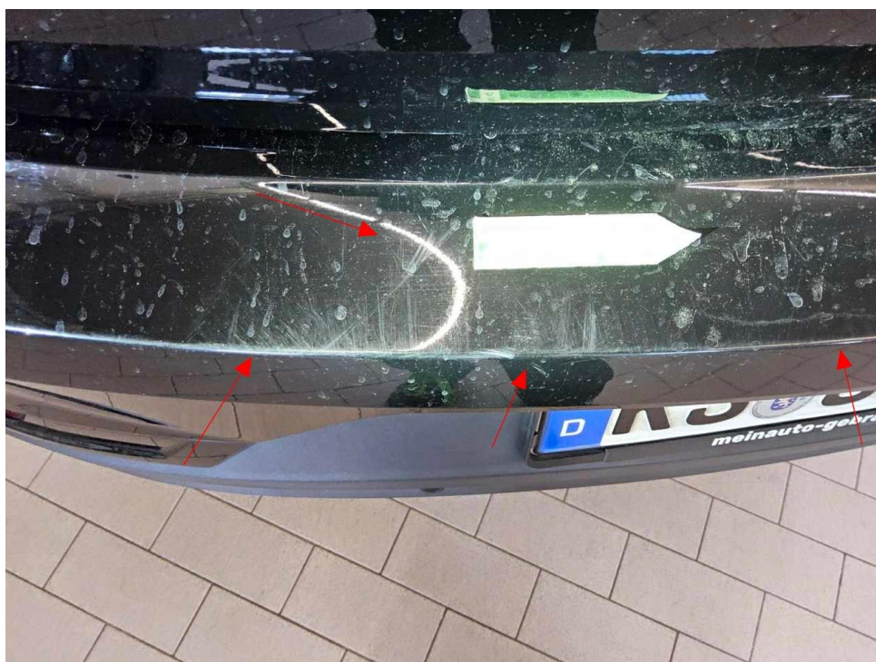
Bild 18 : Stoßfänger hinten Lackierung zerkratzt
