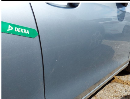
Puerta / Delantero Derecho / Abolladura
