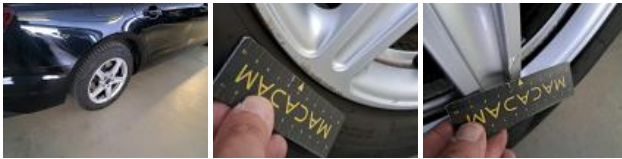
Door RR, Scratch(es), Acceptable
