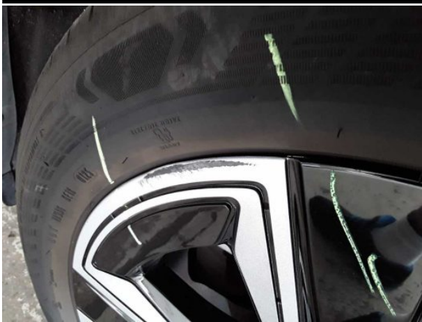
Beschädigung #2: Rad/Reifen: Radblende vorn links (Abdeckung) - verkratzt / verschürft - erneuern
