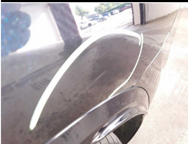
Beschädigung #6: Seitenwand links: Seitenwand - Delle / Lackschaden - Smart Repair
