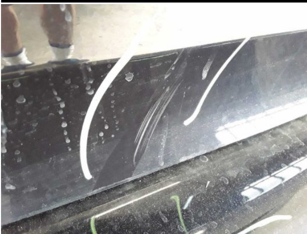
Beschädigung #12: Heckklappe/-tür: Heckklappe - verkratzt / verschürft - instandsetzen und lackieren
