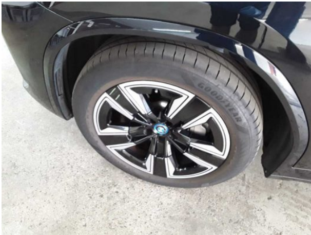
Beschädigung #3: Rad/Reifen: Radblende vorn links (Abdeckung) - verkratzt / verschürft - erneuern
