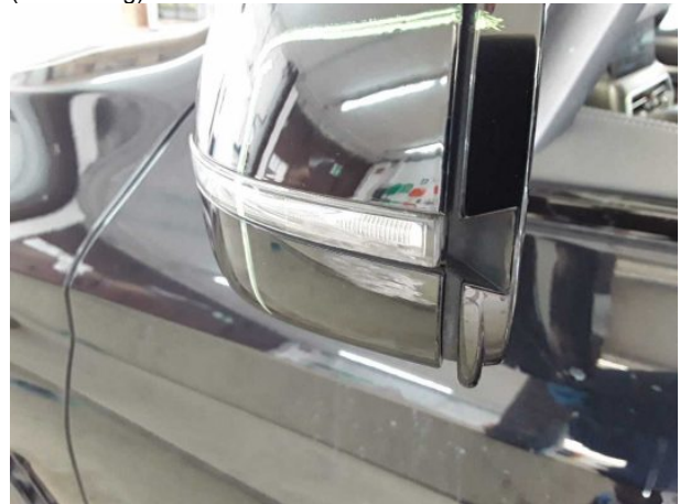
Beschädigung #5: Blinkleuchte: Spiegel links - verkratzt / verschürft - erneuern
