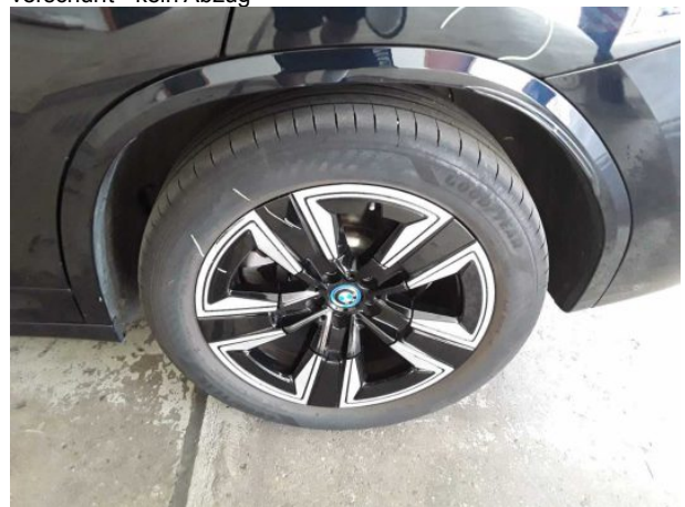
Beschädigung #2: Rad/Reifen: Radblende vorn links (Abdeckung) - verkratzt / verschürft - erneuern
