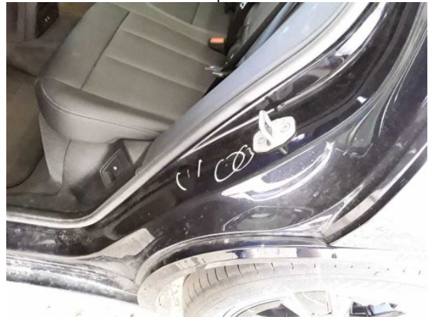
Beschädigung #8: Seitenwand links: Einstieg - Delle / Lackschaden - instandsetzen und lackieren
