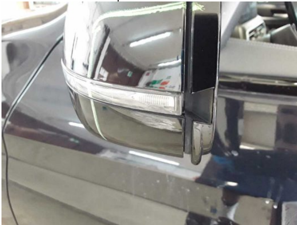
Beschädigung #7: Außenspiegel links: Spiegelgehäuse - verkratzt / verschürft - Smart Repair
