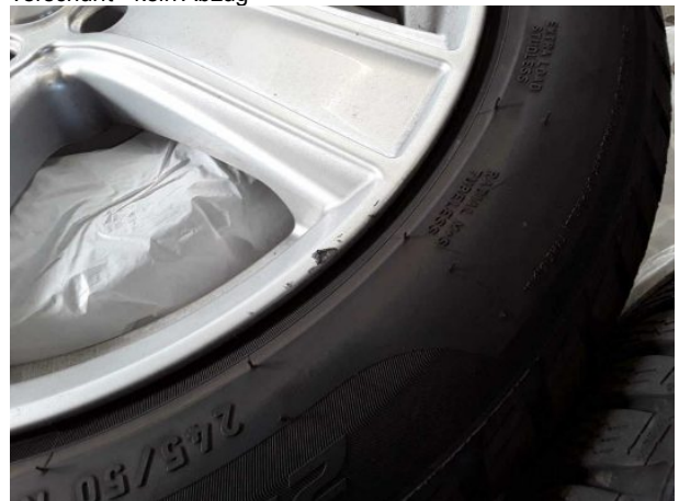
Beschädigung #1: 2.Radsatz: 3 Leichtmetallfelgen - verkratzt / verschürft - kein Abzug
