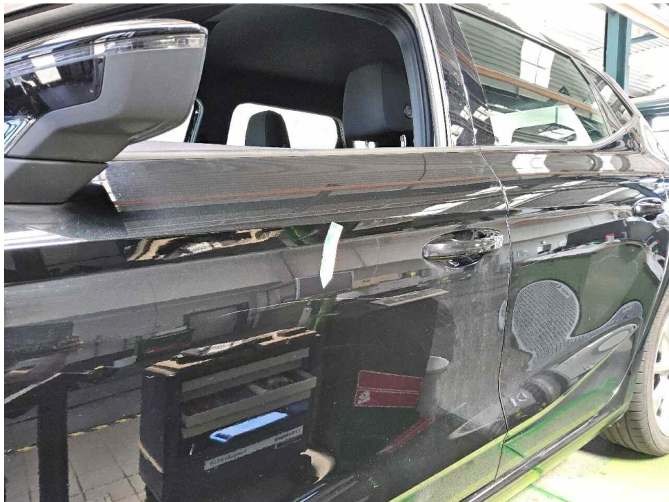
Bild 24 : Streifschaden Tür vorn links, verschrammt
