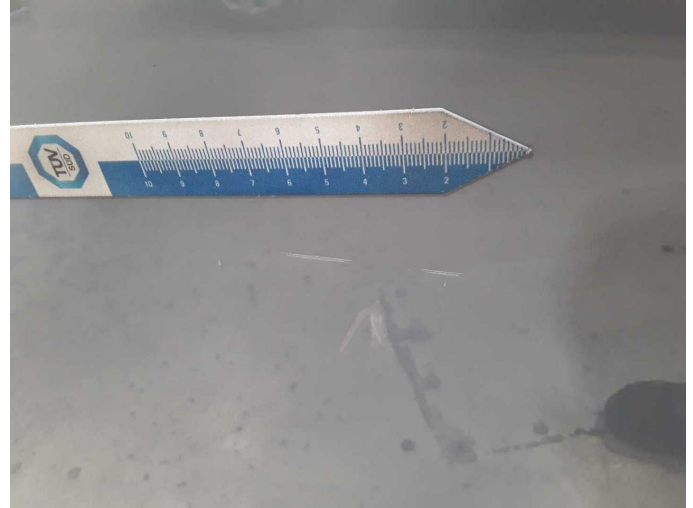
Damage 1: Door - front left side: Door - Scratch(es) - Paint
