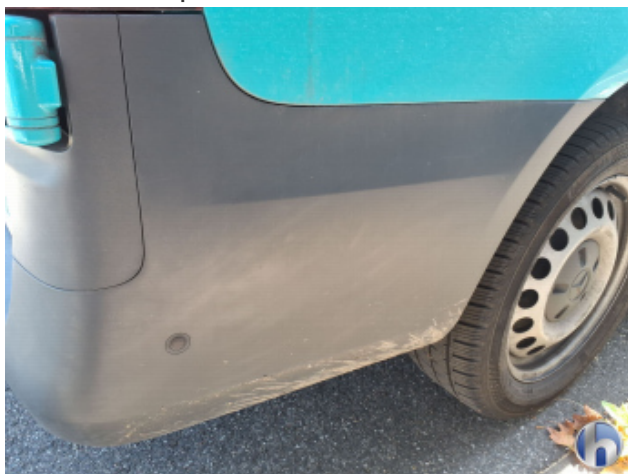
3. Stoßfänger Hinten Beschädigt - Erneuern
