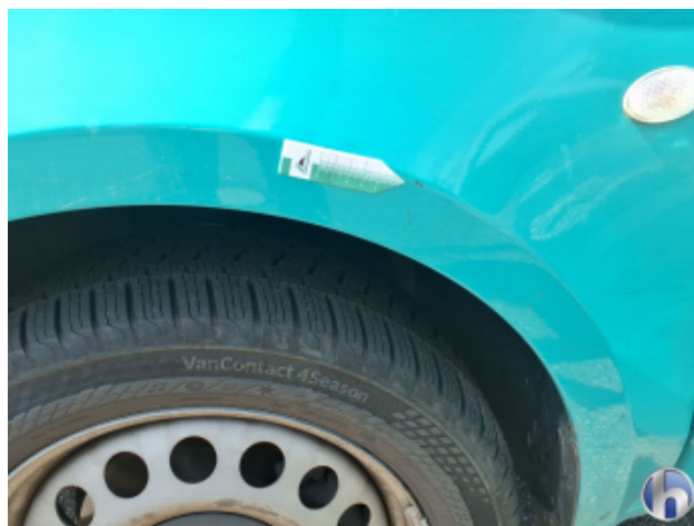
2. Kotflügel Vorne - Links Kratzer - Smart Repair
