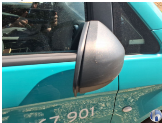
1. Außenspiegel - Rechts Kratzer - Smart Repair
