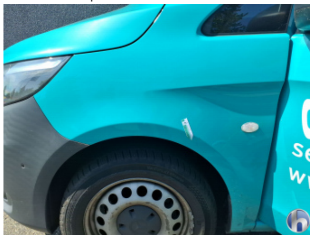
2. Kotflügel Vorne - Links Kratzer - Smart Repair
