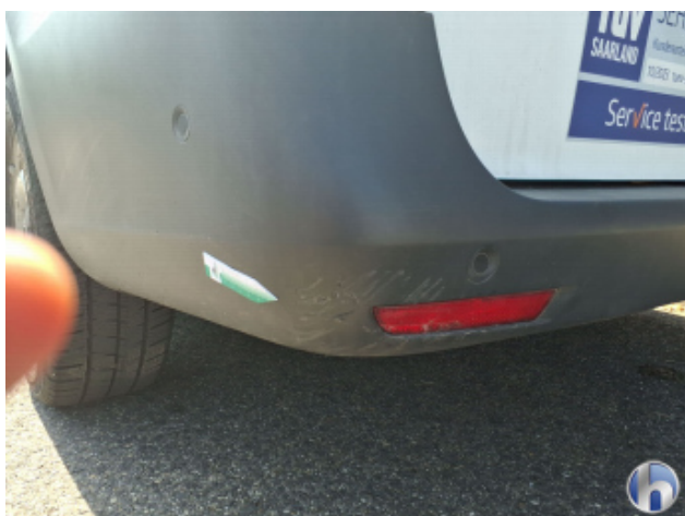
3. Stoßfänger Hinten Beschädigt - Erneuern
