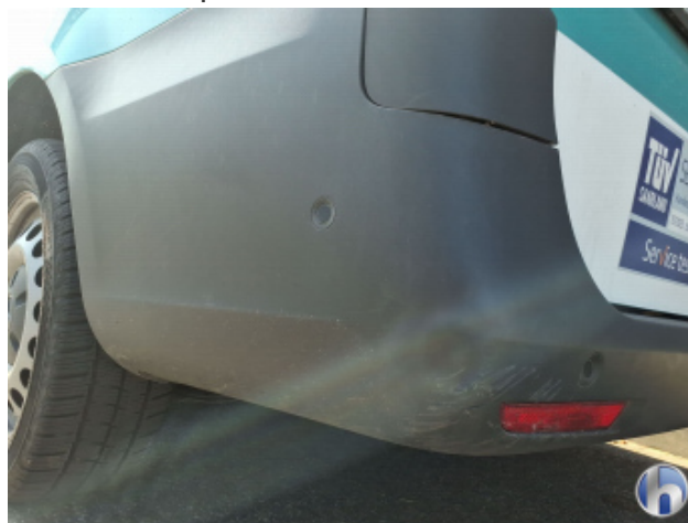
3. Stoßfänger Hinten Beschädigt - Erneuern
