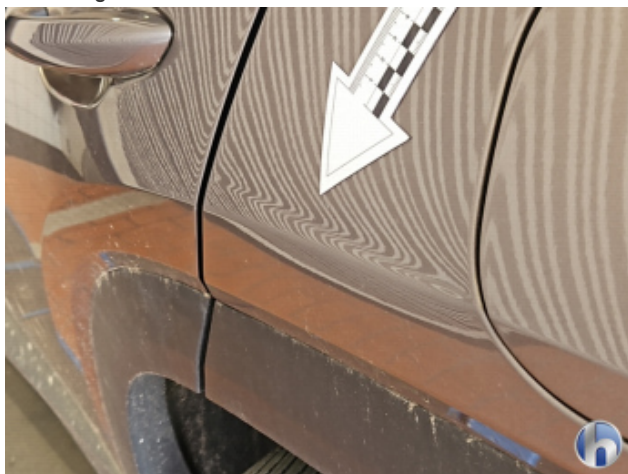
4. Seitenwand - Hinten - Links Beschädigt - Instandsetzen und Lackieren
