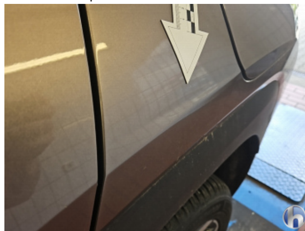
4. Seitenwand - Hinten - Links Beschädigt - Instandsetzen und Lackieren
