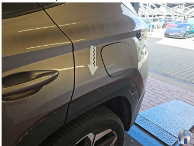
4. Seitenwand - Hinten - Links Beschädigt - Instandsetzen und Lackieren
