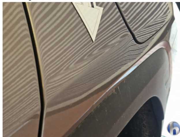
4. Seitenwand - Hinten - Links Beschädigt - Instandsetzen und Lackieren
