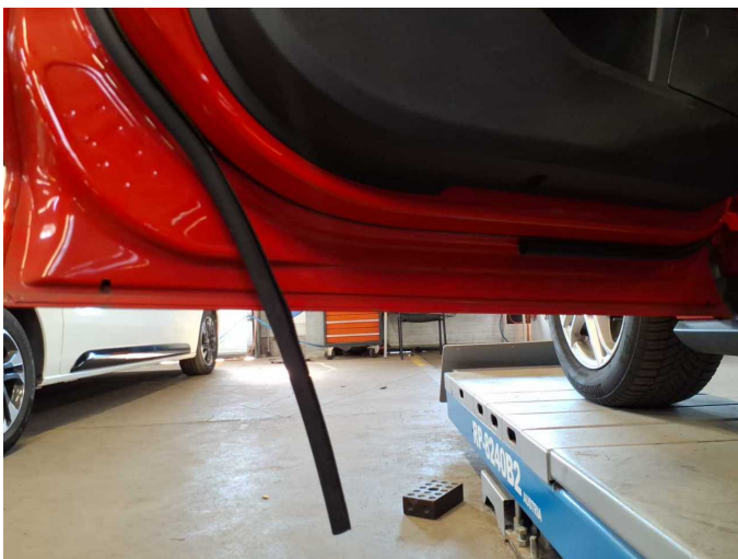
Damage 5: Door - front left side: Door (Dichtung) - Damaged - Replace
