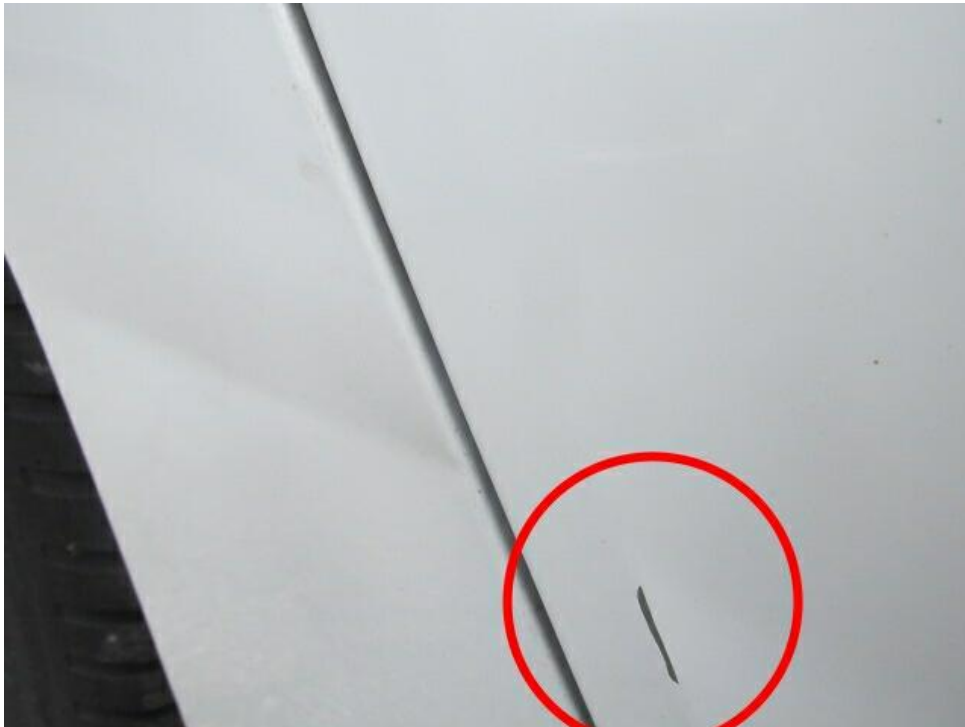
Bild 19 : Türe hinten rechts deformiert
