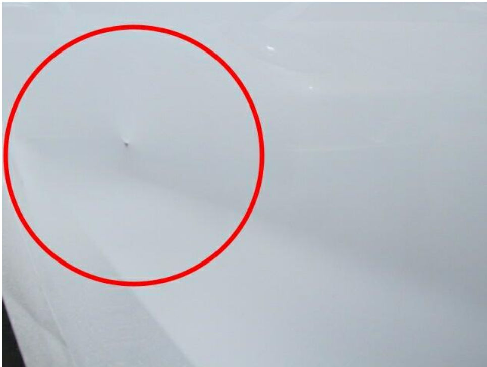
Bild 17 : Türe hinten rechts deformiert
