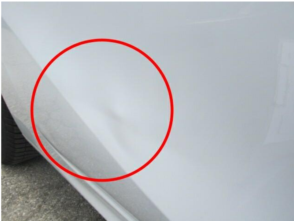
Bild 16 : Türe hinten rechts deformiert
