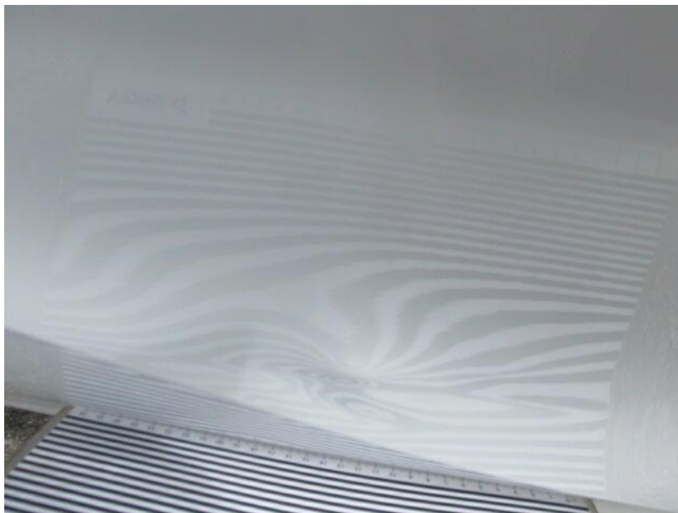
Bild 28 : Türe hinten rechts deformiert
