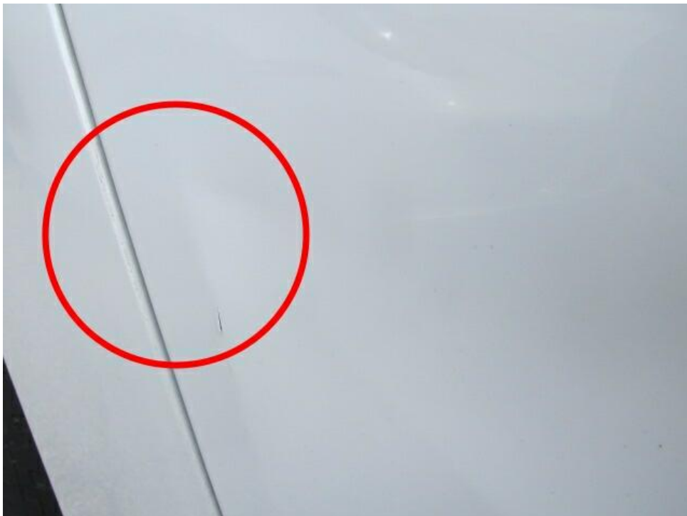
Bild 18 : Türe hinten rechts deformiert
