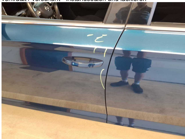
Beschädigung #6: Tür vorn links: Tür - verkratzt / verschürft - instandsetzen und lackieren
