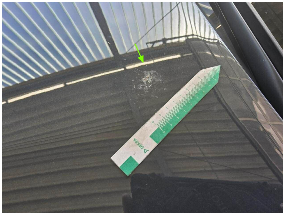
Bild 12 : Motorhaube Lackierung, Umweltschaden, lackieren mit Lackaufbau
