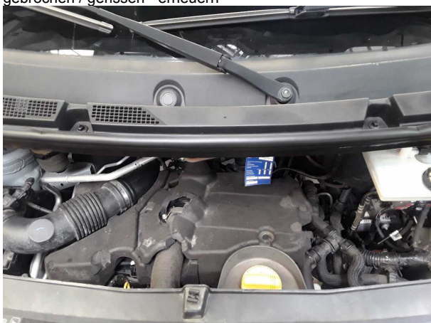
Beschädigung #3: Motor: Motorabdeckung - Marderschaden - erneuern
