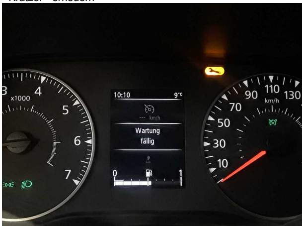
Beschädigung #6: Sonstiges: Inspektion/Wartung - fällig - durchführen
