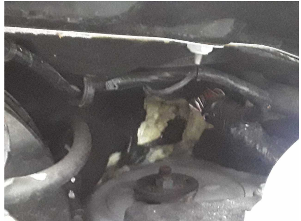
Beschädigung #4: Karosserie: Stirnwandverkleidung - Marderschaden - erneuern
