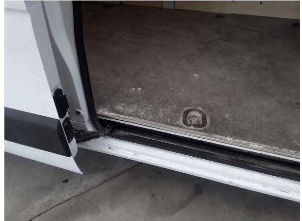
Beschädigung #1: Interieur: Laderaumboden (Leiste) - lose - de-/montieren
