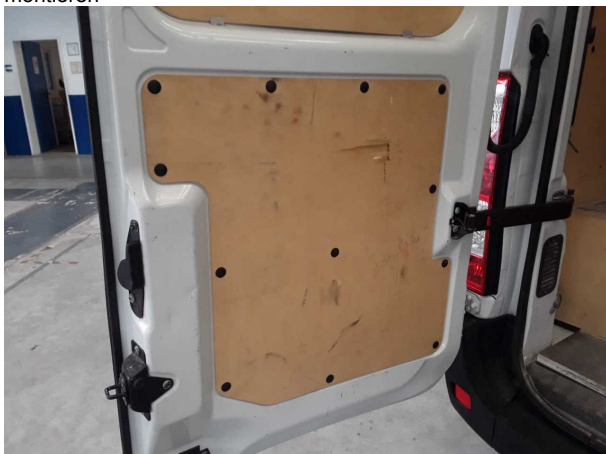
Beschädigung #2: Heckklappe/-tür: Verkl. Hecktür Sperrholz unten - gebrochen / gerissen - erneuern
