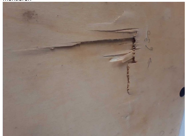
Beschädigung #2: Heckklappe/-tür: Verkl. Hecktür Sperrholz unt... - gebrochen / gerissen - erneuern
