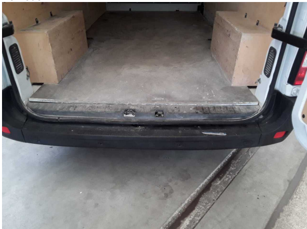
Beschädigung #5: Stossfänger hinten: Stossfänger hinten (unlackiert) - Kratzer - erneuern
