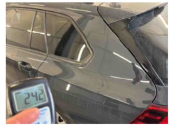
Lackstärke Seitenwand hinten links
