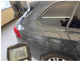
Lackstärke Seitenwand hinten rechts
