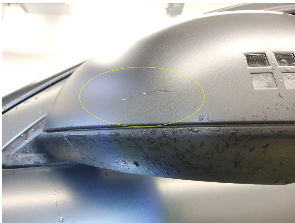
Bild 8 : Außenspiegel links Gehäuse, zerkratzt, lackieren mit Lackaufbau
