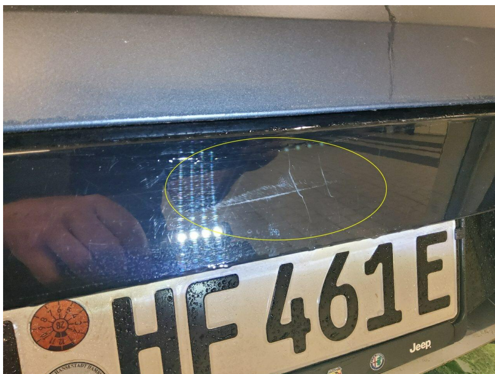
Bild 10 : Mittelblende Stoßfänger hinten verschrammt
