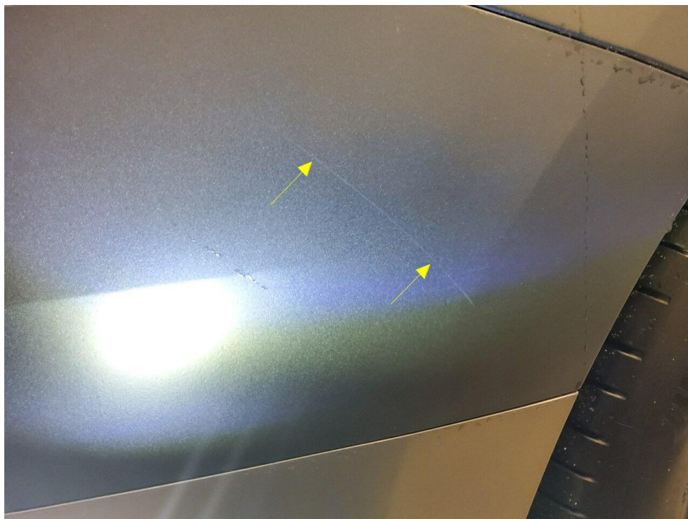
Bild 17 : Stoßfängerverkleidung hinten rechts zerkratzt
