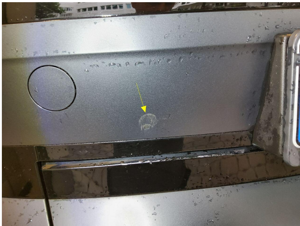
Bild 14 : Stoßfänger vorne Lackierung, verschrammt, lackieren mit Lackaufbau
