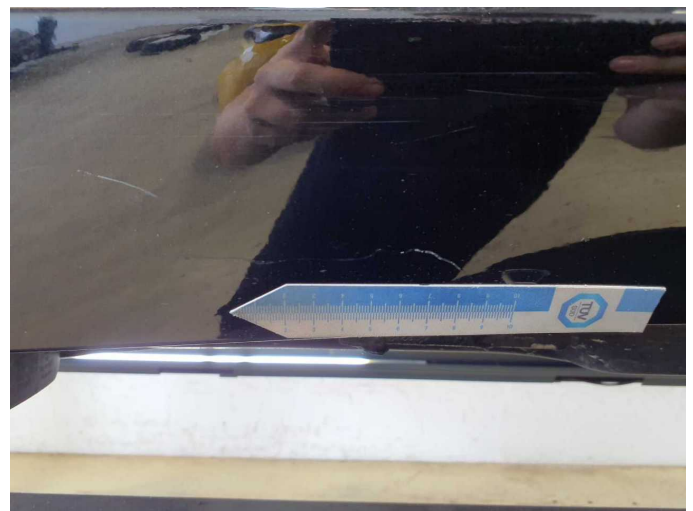
Damage 7: Door - rear right side: Door (Zierleiste unten) - Scratch(es) - Paint
