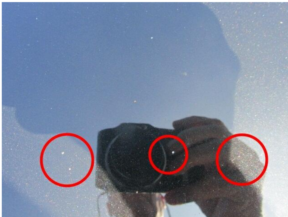
Bild 14 : Motorhaube erhebliche Steinschläge
