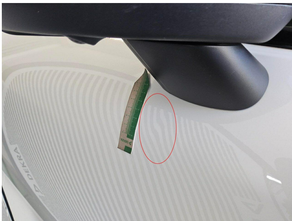
Bild 18 : Tür vorne rechts, eingedellt, Gebrauchsspur
