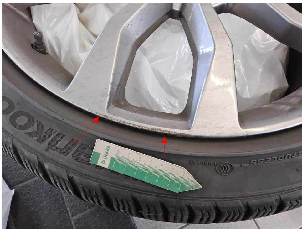
Bild 30 : Felge vorne links Lackierung, zerkratzt, smart repair Winterradsatz
