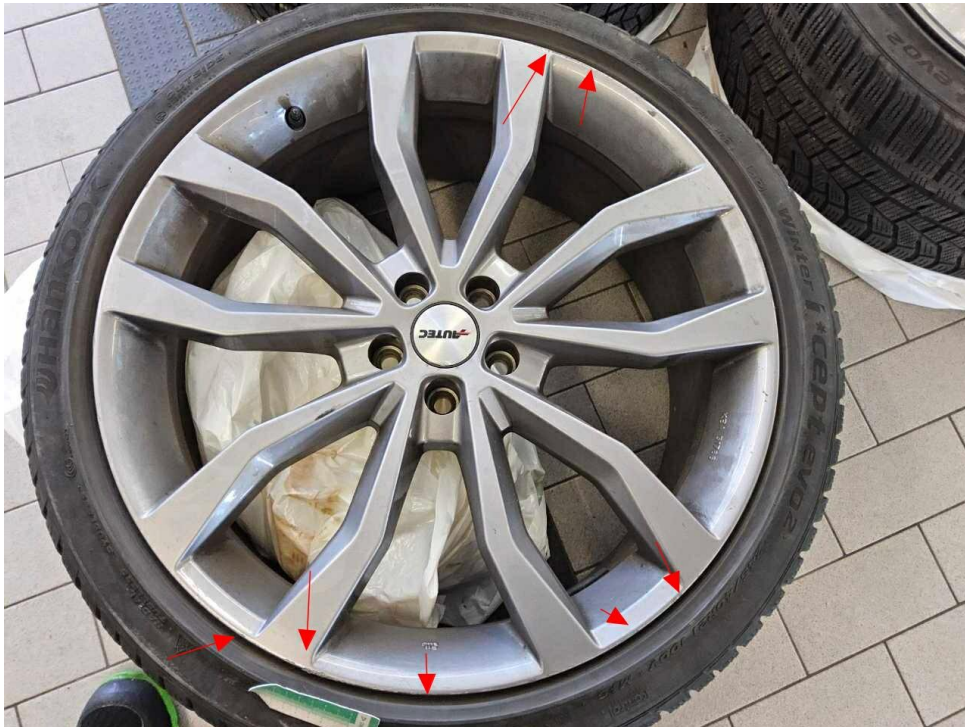
Bild 31 : Felge vorne rechts, zerkratzt, erneuern Winterradsatz
