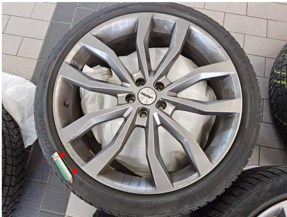
Bild 29 : Felge vorne links Lackierung, zerkratzt, smart repair Winterradsatz
