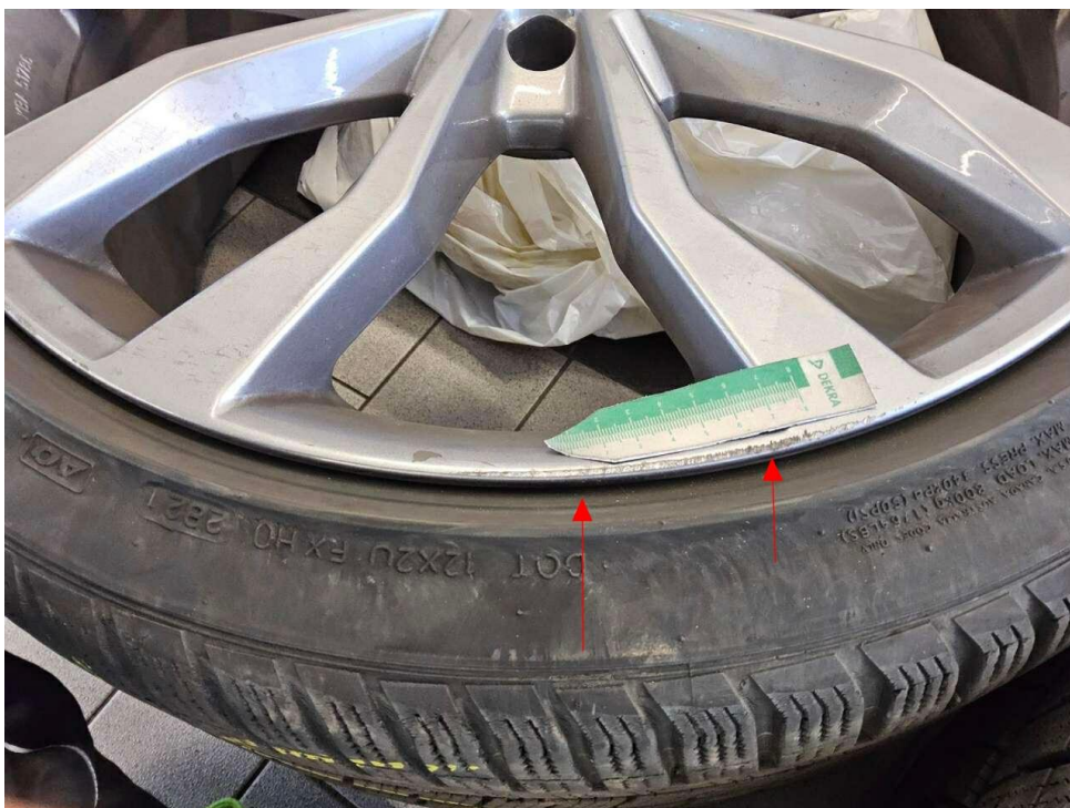
Bild 32 : Felge vorne rechts, zerkratzt, erneuern Winterradsatz
