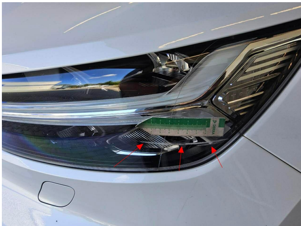
Bild 26 : Scheinwerfer links Glas, gerissen, erneuern
