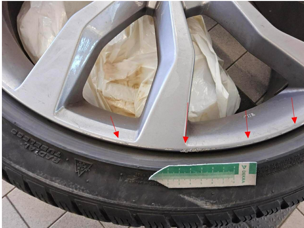
Bild 33 : Felge vorne rechts, zerkratzt, erneuern Winterradsatz
