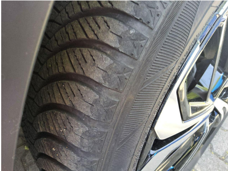
Bild 9 : Reifen vorne außen abgefahren
