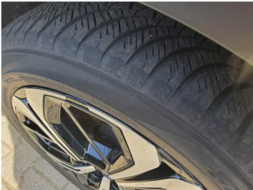
Bild 10 : Reifen vorne außen abgefahren
