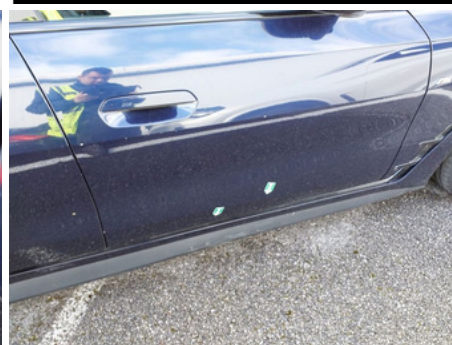
Revêtement de bas de caisse / Droit / Rayure
