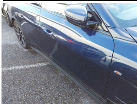
Porte / Avant Droit / Enfoncement
