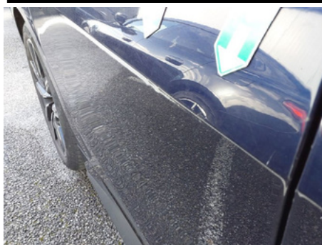
Porte / Arrière Droit / Enfoncement
