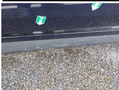
Revêtement de bas de caisse / Droit / Rayure
