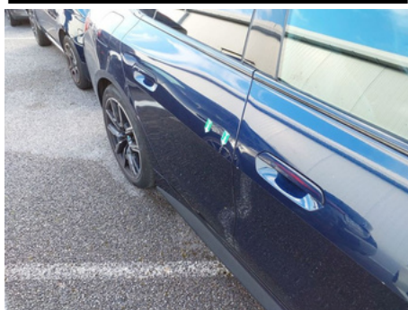
Porte / Arrière Droit / Enfoncement
