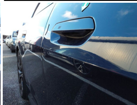
Porte / Avant Droit / Enfoncement
