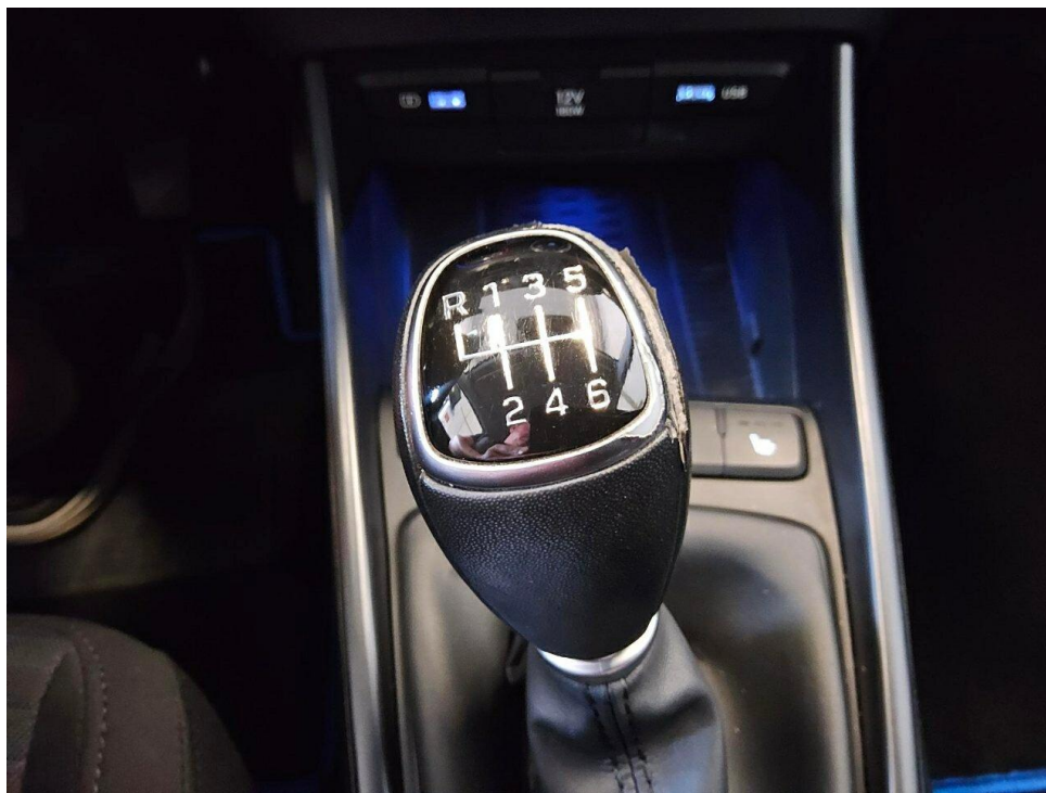
Bild 12 : Schalthebel, verschlissen, erneuern
