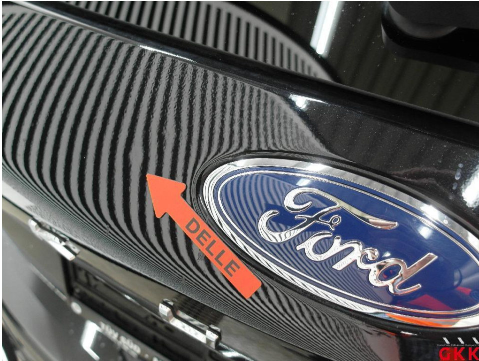
Bild 25. Heckklappe, bis 3 Dellen / Bauteil, kalt drücken
