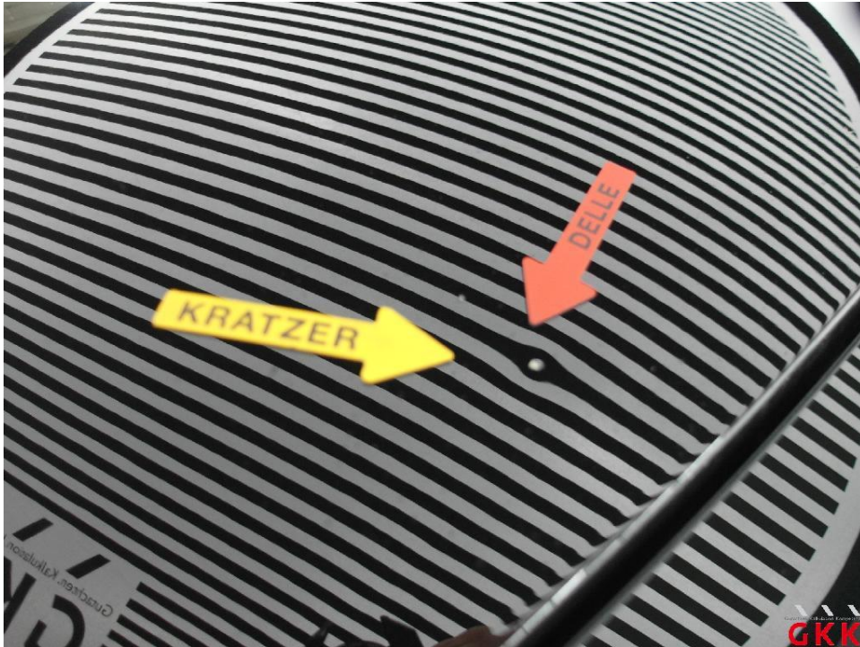
Bild 17. Dach, bis 3 Dellen / Bauteil, kalt drücken
