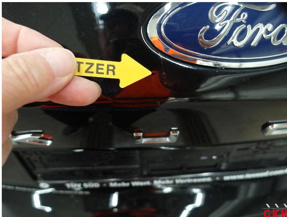
Bild 23. Heckklappe, verkratzt, auslegen, schleifen, polieren
