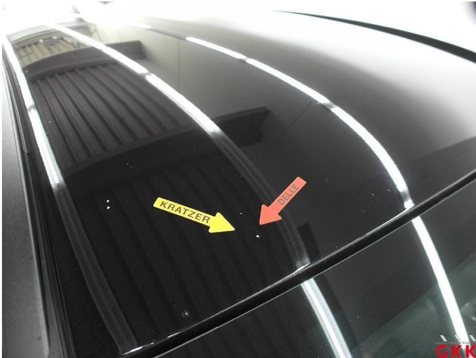
Bild 18. Dach, vorne, Steinschlag und Kratzer, auslegen, schleifen, polieren
