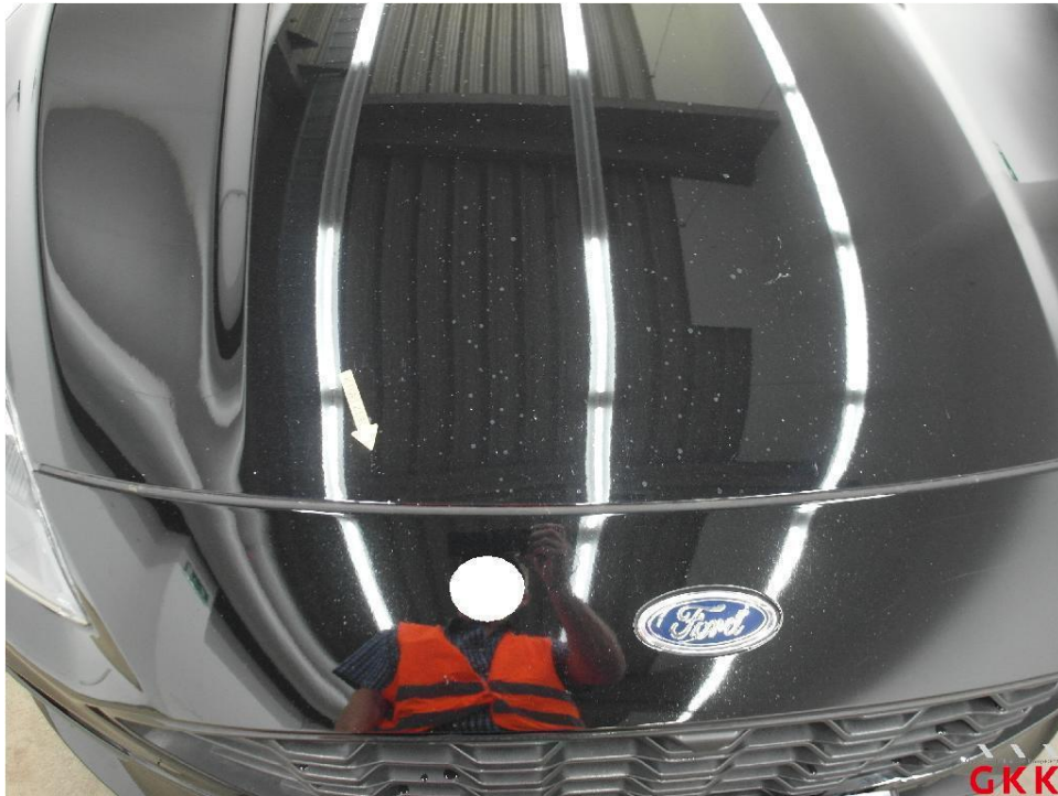
Bild 15. Motorhaube, Steinschlag, auslegen, schleifen, polieren
