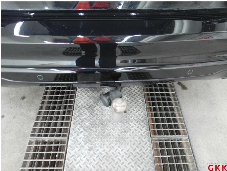
Bild 26. Stoßfänger hinten, Verkleidung oberhalb -lackiert-, verkratzt, auslegen, schleifen, polieren
