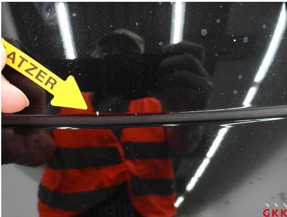
Bild 16. Motorhaube, Steinschlag, auslegen, schleifen, polieren
