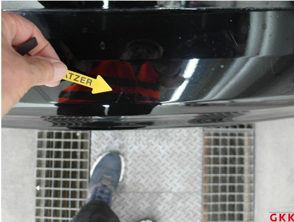
Bild 27. Stoßfänger hinten, Verkleidung oberhalb -lackiert-, verkratzt, auslegen, schleifen, polieren
