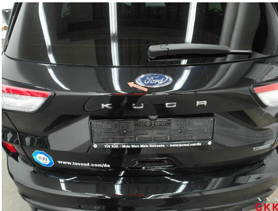
Bild 24. Heckklappe, bis 3 Dellen / Bauteil, kalt drücken
