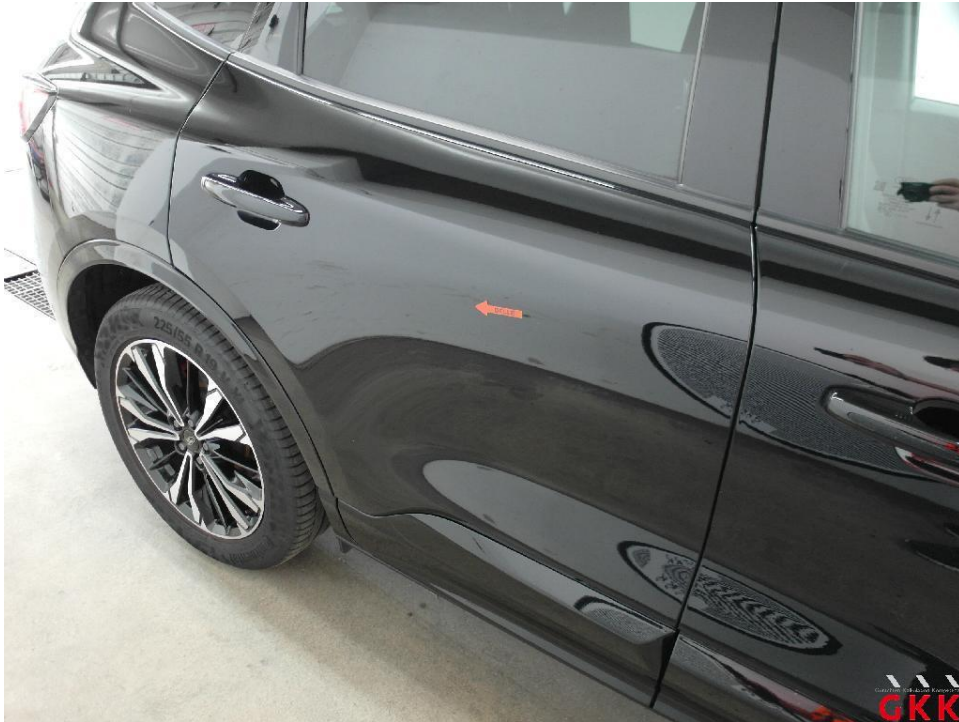
Bild 21. Tür hinten rechts, bis 3 Dellen / Bauteil, kalt drücken
